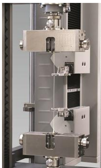
Slika 10. Mjerenje „sensor arm“ ekstenzometrom [48]
