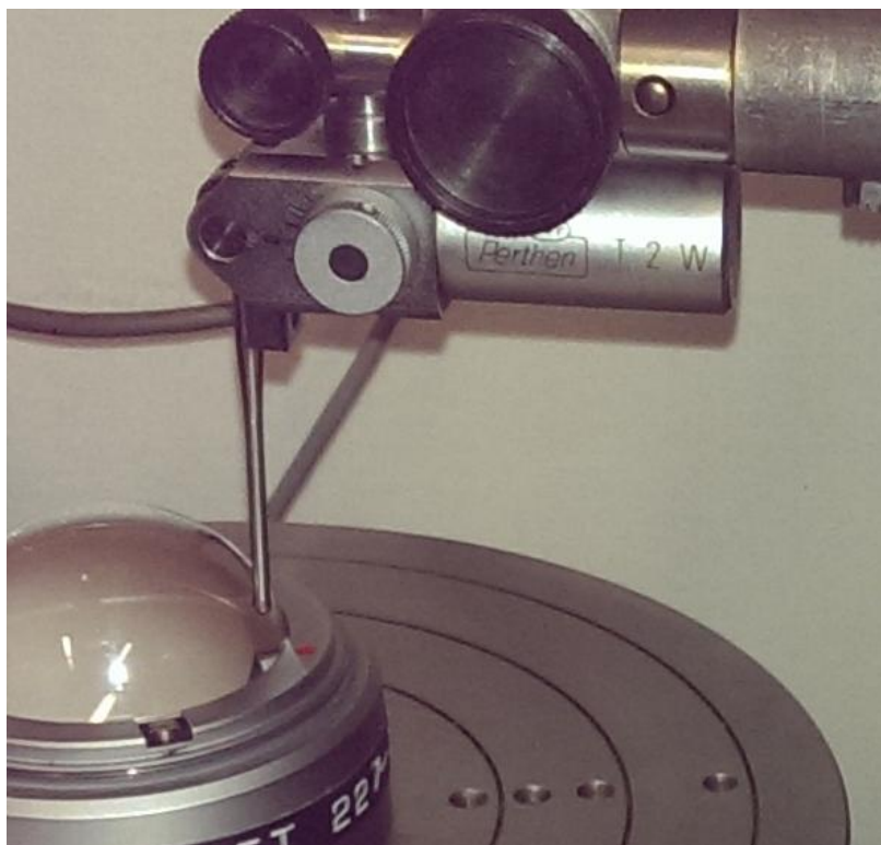
Slika 9. Induktivno ticalo i ruka ticala
