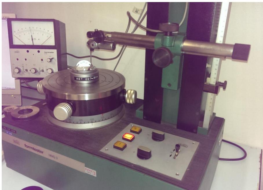
*Slika 13. 3D prikaz uređaja za mjerjenje kružnosti Mahr MMQ3*
