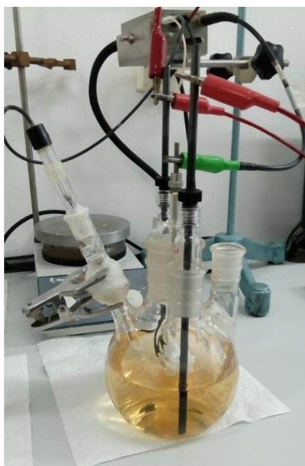
Slika 30. Ispitni uzorak u 3,5 % otopini NaCl s inhibitorom koncentracije 0,1 %
