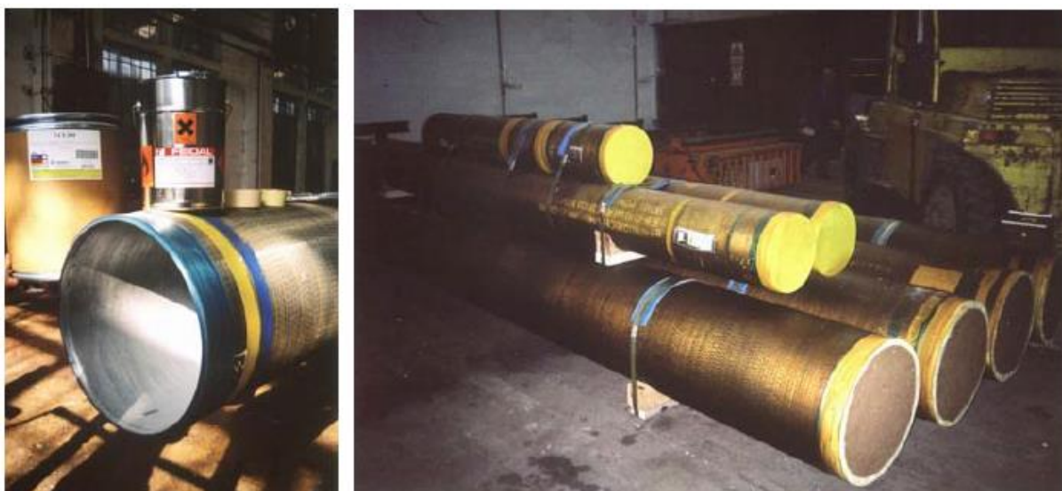
Slika 14. Privremena zaštita unutrašnjosti cijevi praškastim inhibitorima korozije [9]
