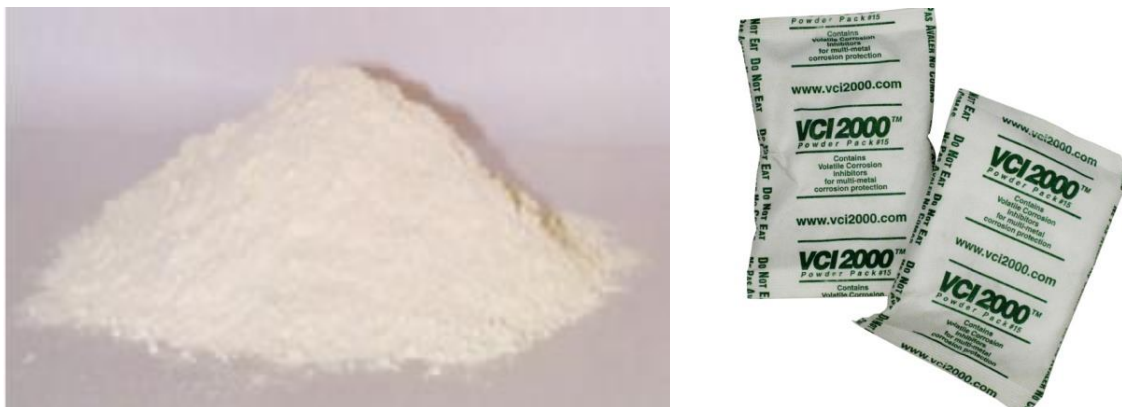
Slika 8. VCI prah (lijevo); VCI prah u obliku emitera (desno) [11]
