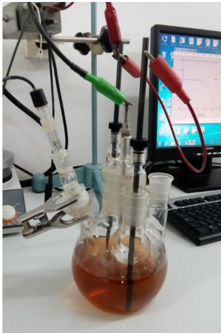
Slika 28. Ispitni uzorak u 3,5 % otopini NaCl s inhibitorom koncentracije 0,5 %
