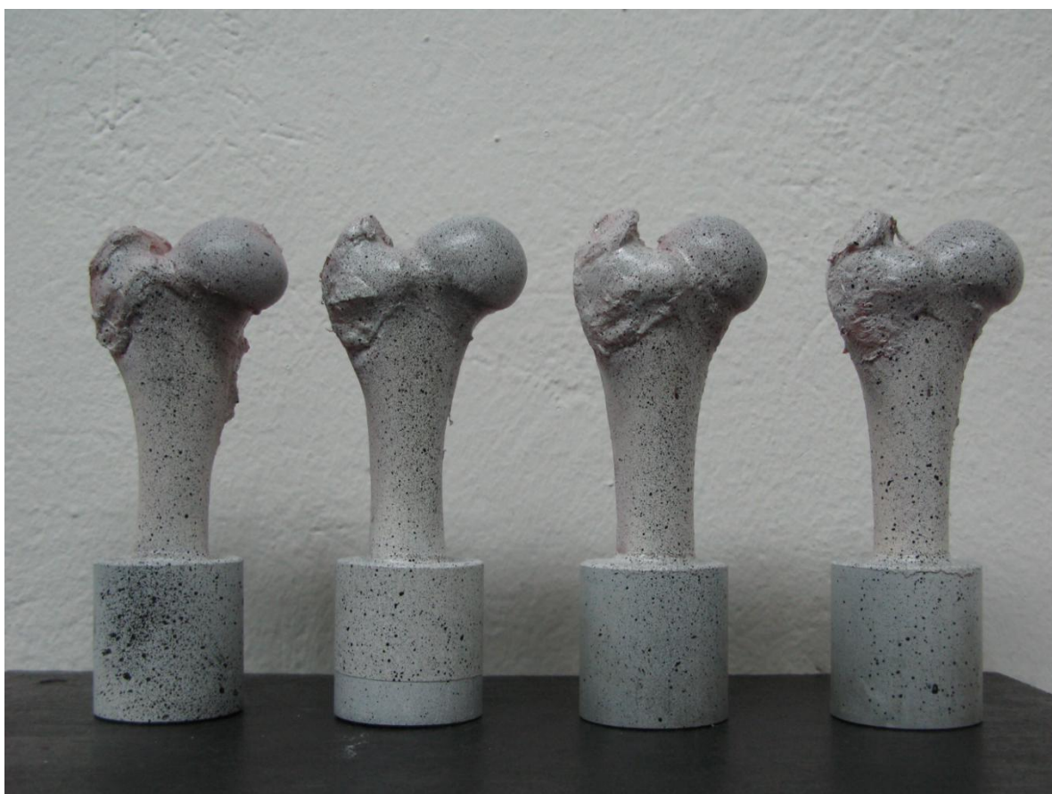
Slika 20. Uzorci nakon nanošenja stohastičkog rastera
