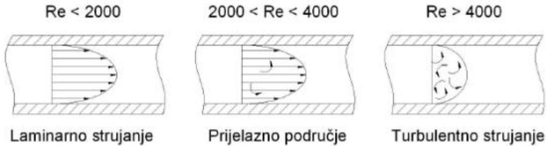
Slika 2: Laminarno, prijelazno i turbulentno strujanje
