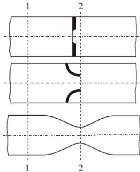
Slika 4. Mjerna prigušnica, mjerna sapnica, Venturijeva cijev[1]
