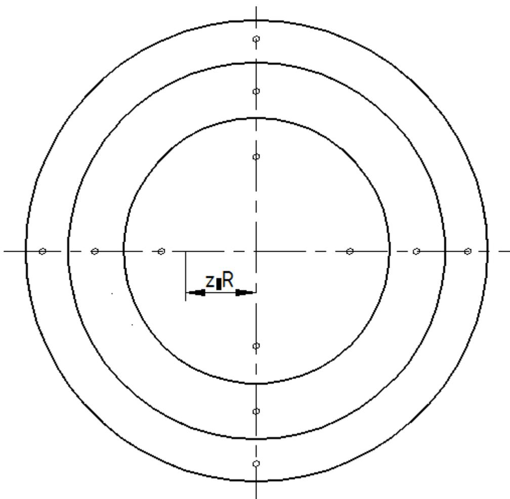
Slika 16: Mjerne točke kod tangentnog pravila
