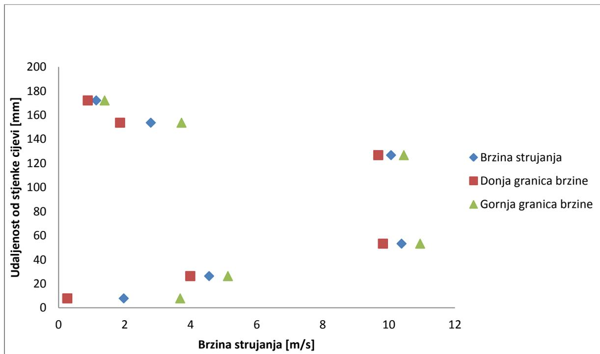
Slika 22: Grafički prikaz brzina za mjerenje mikromanometrom
