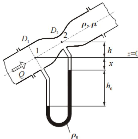
Slika 6: Venturijeva cijev[1]
