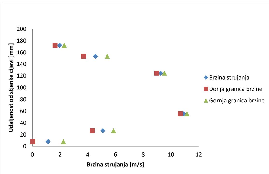
Slika 18: Grafički prikaz brzina za mjerenje mikromanometrom
