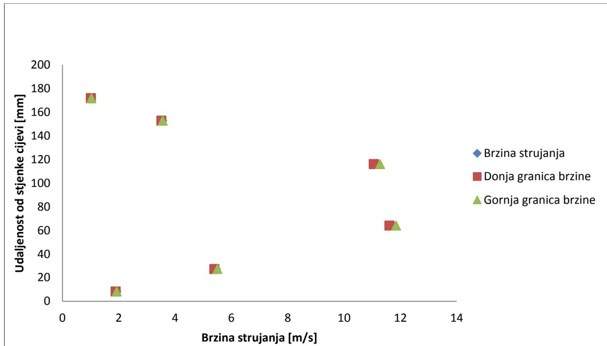
Slika 21: Grafički prikaz brzina izmjerenih diferencijalnim pretvornikom tlaka
