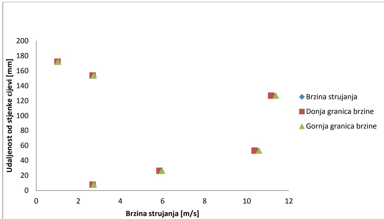
Slika 23: Grafički prikaz brzina izmjerenih diferencijalnim pretvornikom tlaka
