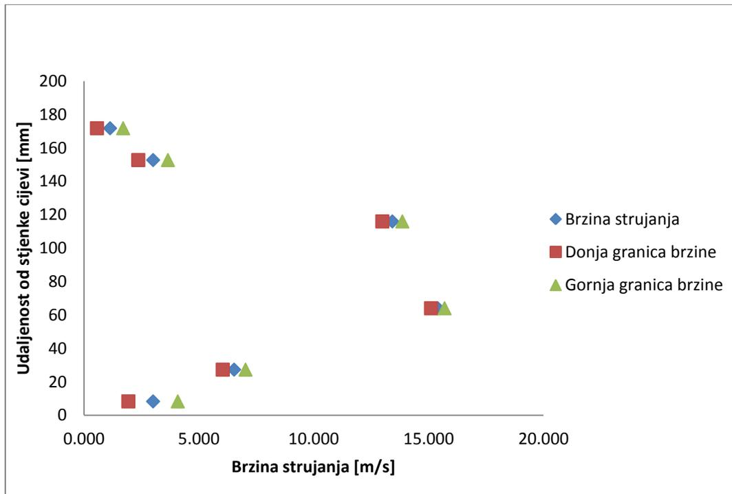
Slika 26: Grafički prikaz brzina za mjerenje mikromanometrom (protok 2)
