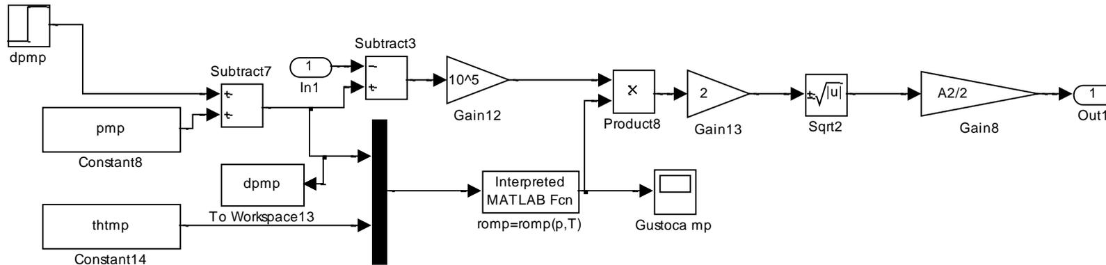
Schema Simulink modela jednadžbe strujanja pare za hladno međupregrijanje
