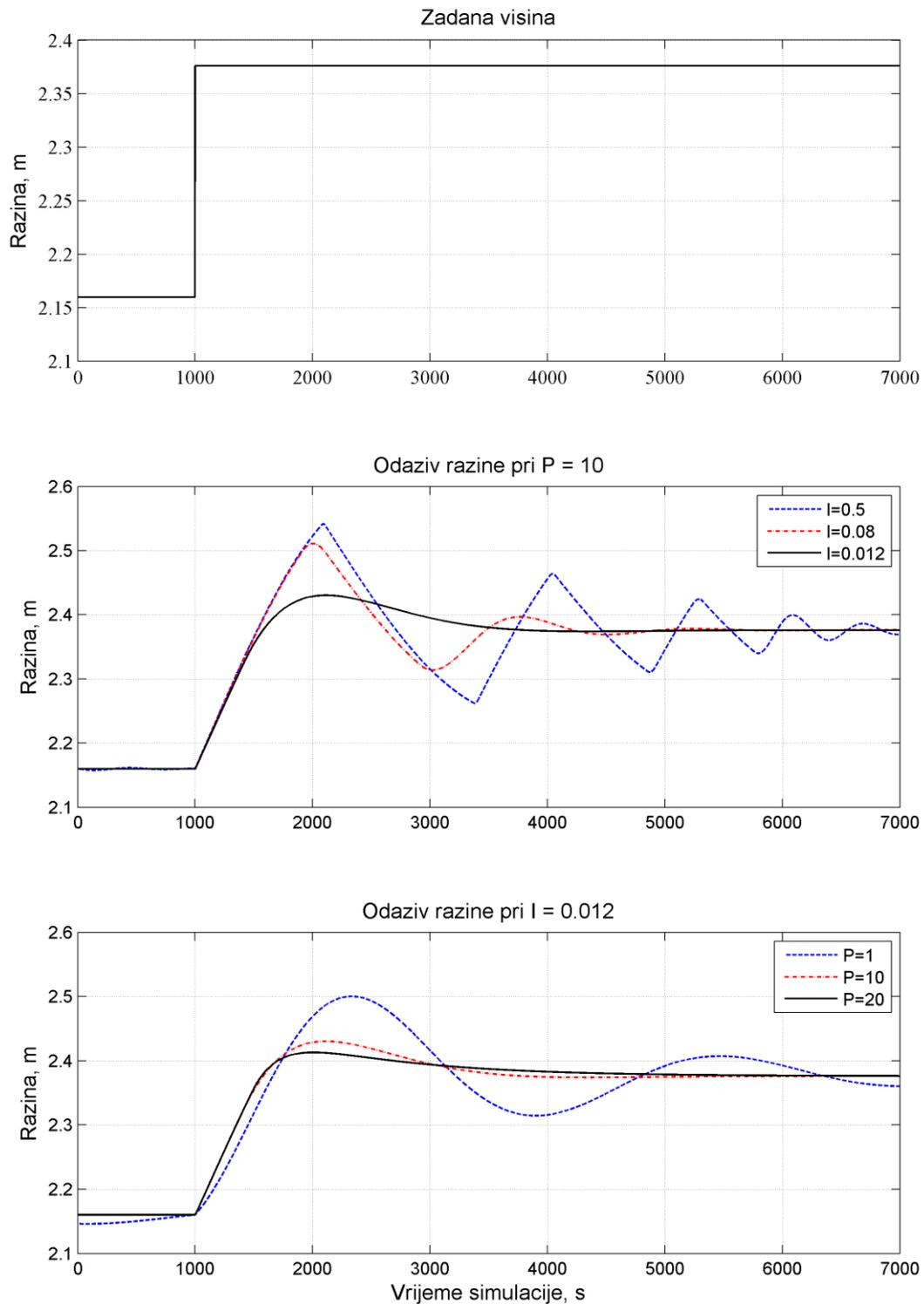
Slika 18. Promjena razine stupca vode pri promjeni P i I parametara sporijeg regulatora
