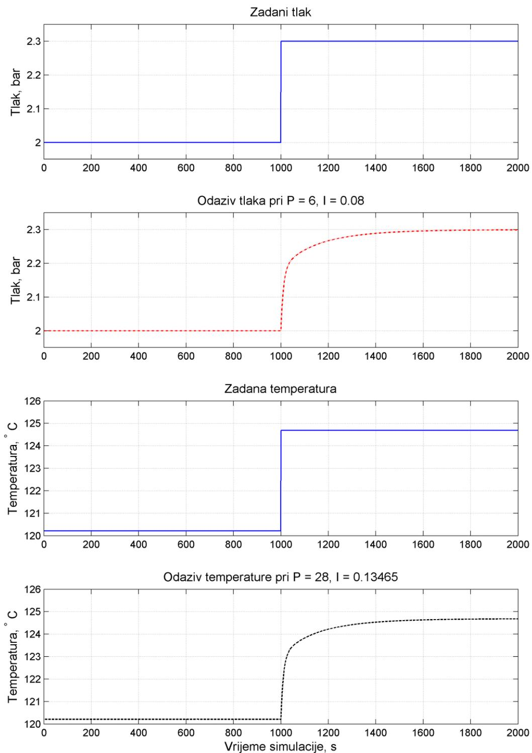
Slika 22. Promjena tlaka i temperature pri tlaku prigušenja pregrijane pare 2.5 bar
