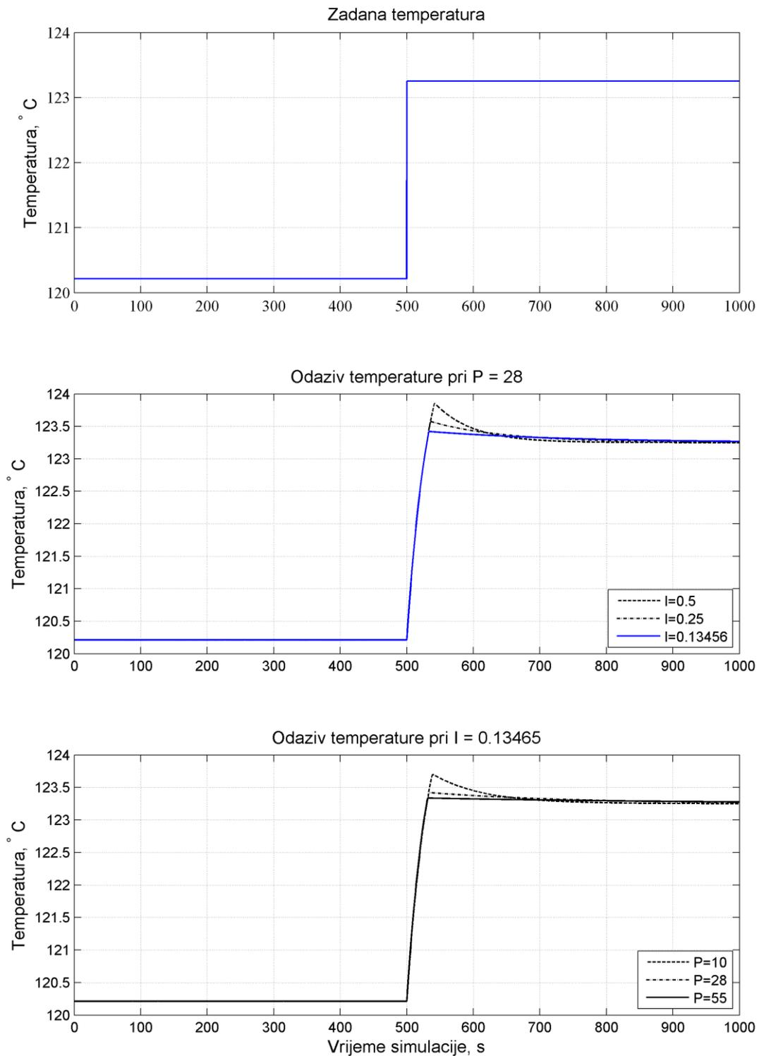
Slika 19. Promjena temperature pri promjeni P i I parametara regulatora temperature
