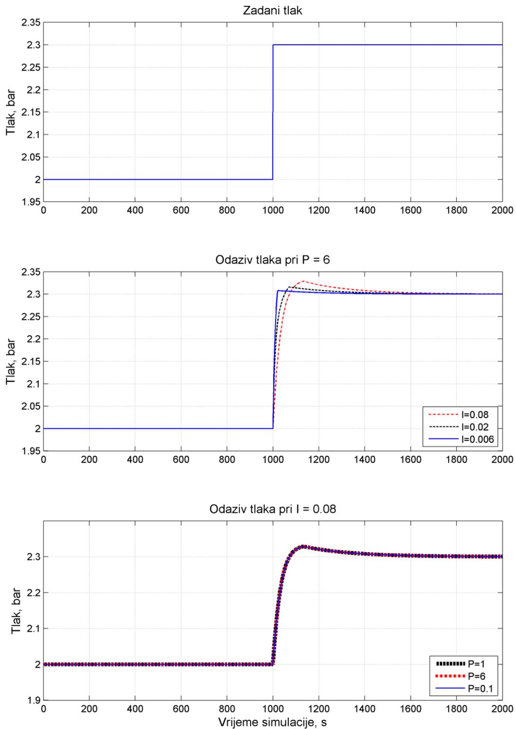
Slika 20. Promjena tlaka pri promjeni P i I parametara regulatora tlaka
