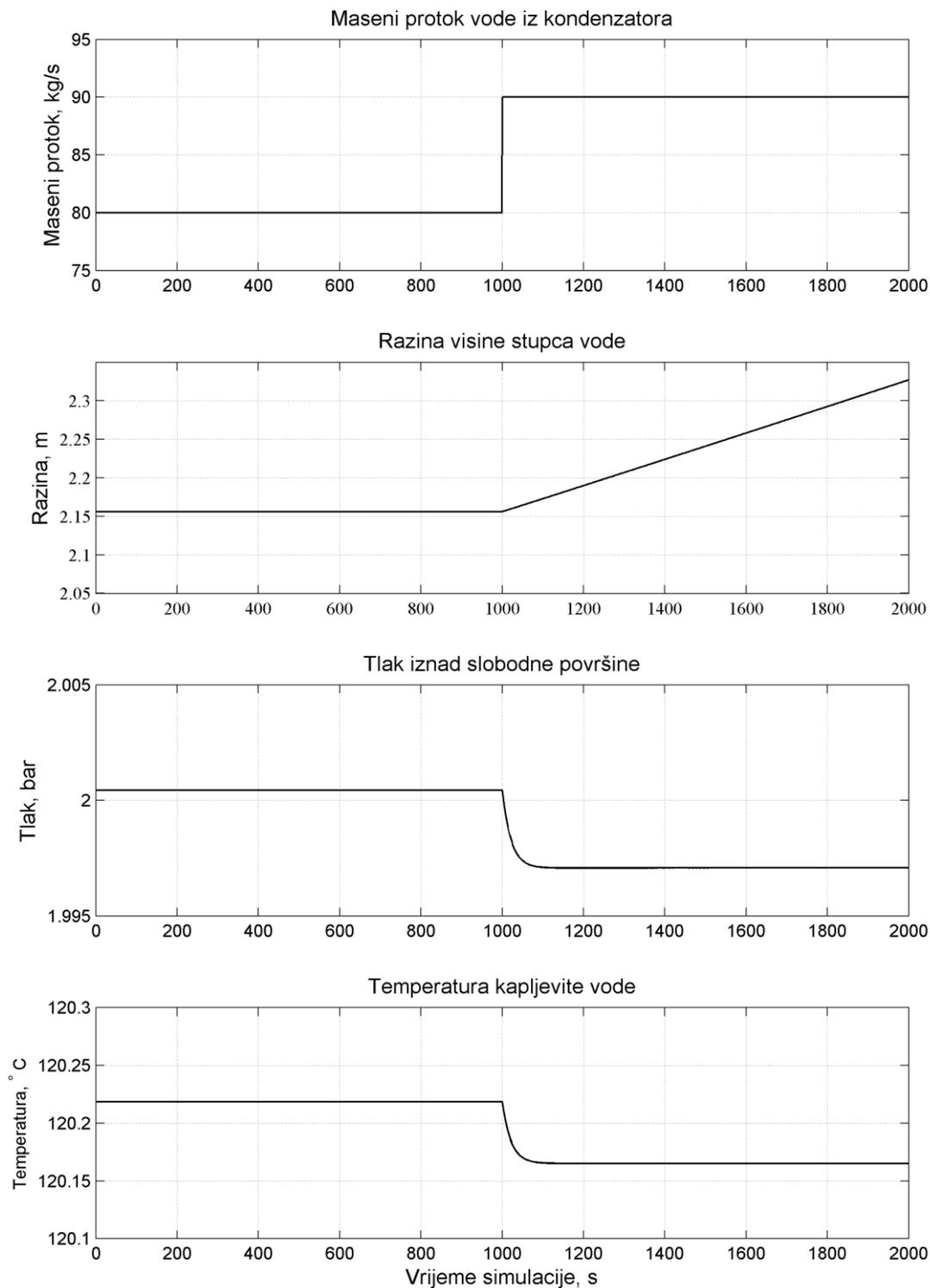
Slika 7. Promjena procesnih veličina pri poremećaju masenog protoka vode iz kondenzatora
