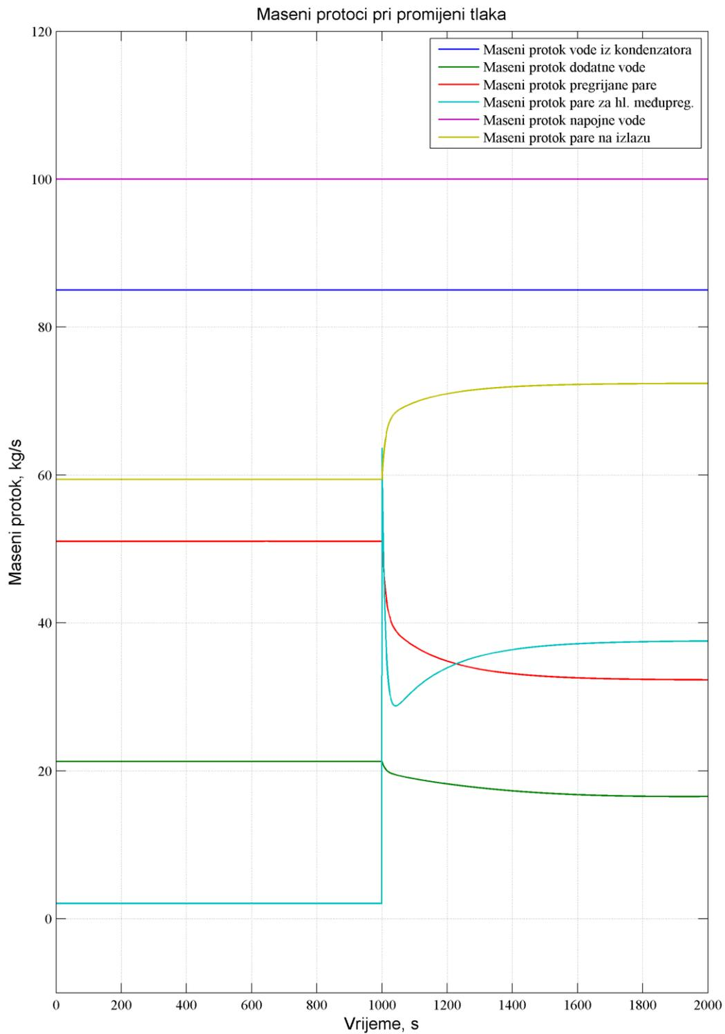
Slika 23. Maseni protoci pri tlaku prigušenja pregrijane pare 2.5 bar i poremećaju tlaka
