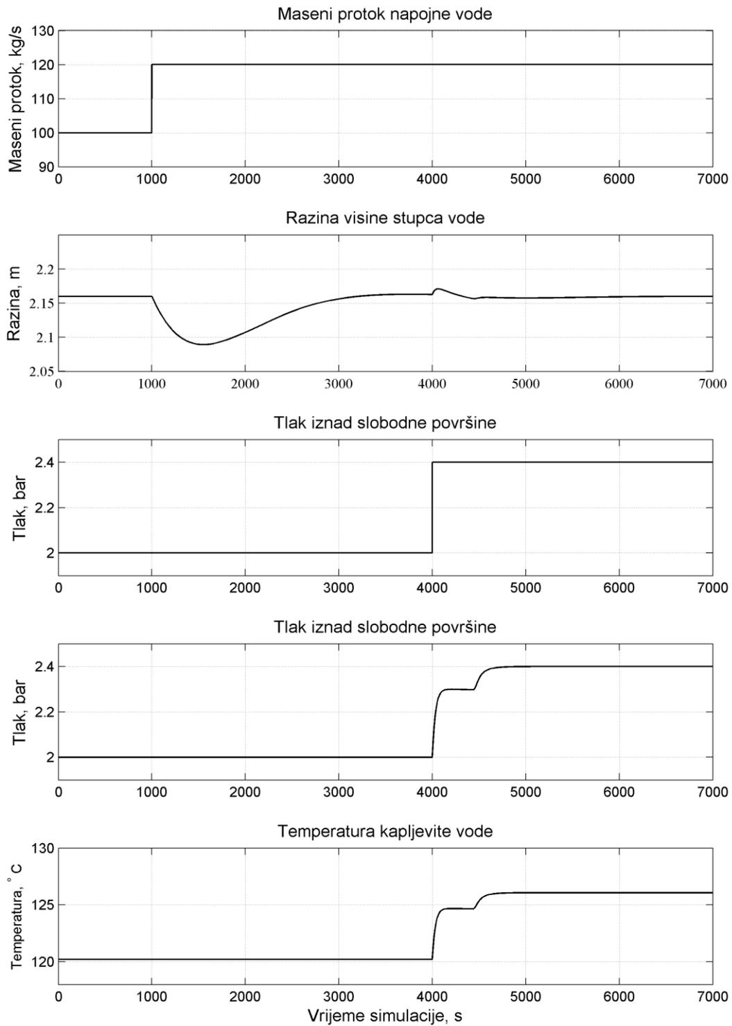
Slika 24. Odaziv reguliranih veličina pri povećanju protoka napojne vode i povećanja tlaka
