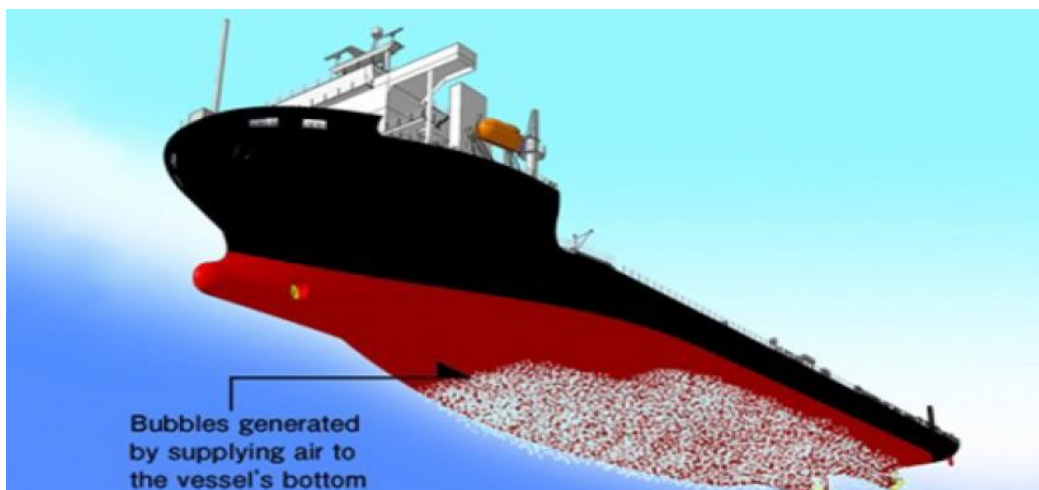
Slika 18. Skica sustava zračnog podmazivanja [16]
