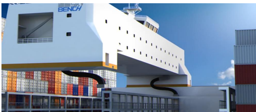
Slika 3. Klizno nadgrađe kontejnerskog broda SkyBench™ [2]
