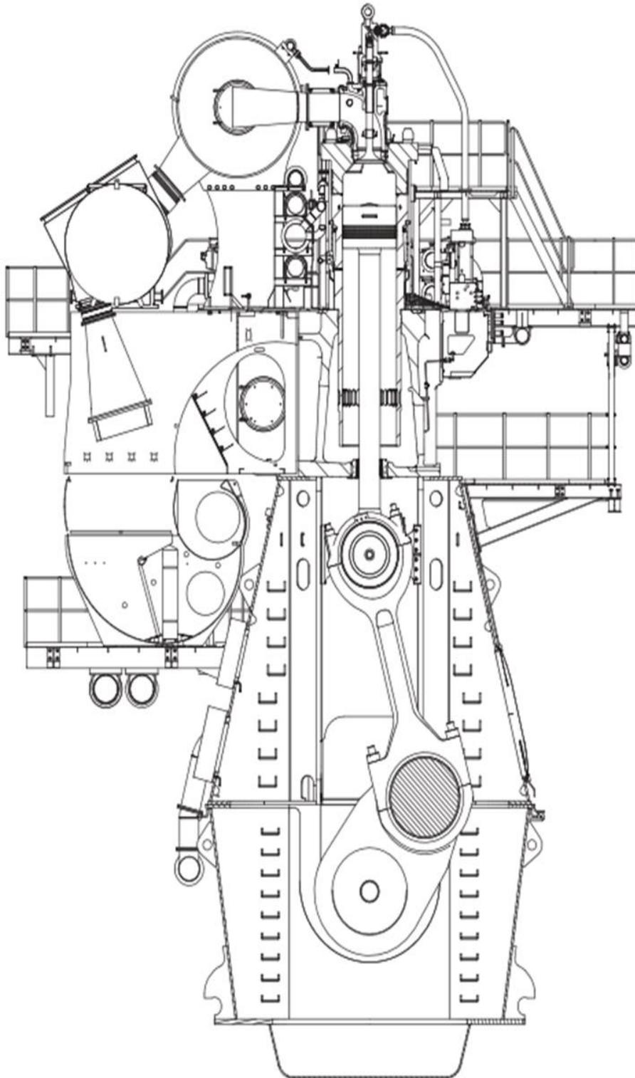
Slika 13. Poprečni presjek glavnog (porivnog) motora [11]
