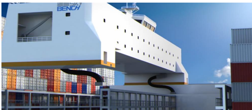
Slika 3. Klizno nadgrađe kontejnerskog broda SkyBench™ [2]
