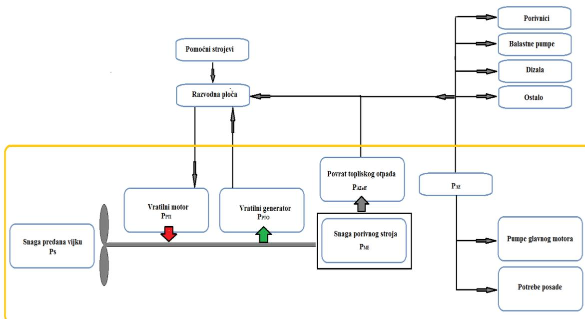
Slika 11. Pojednostavljena generička shema broskog energetskog sustava
