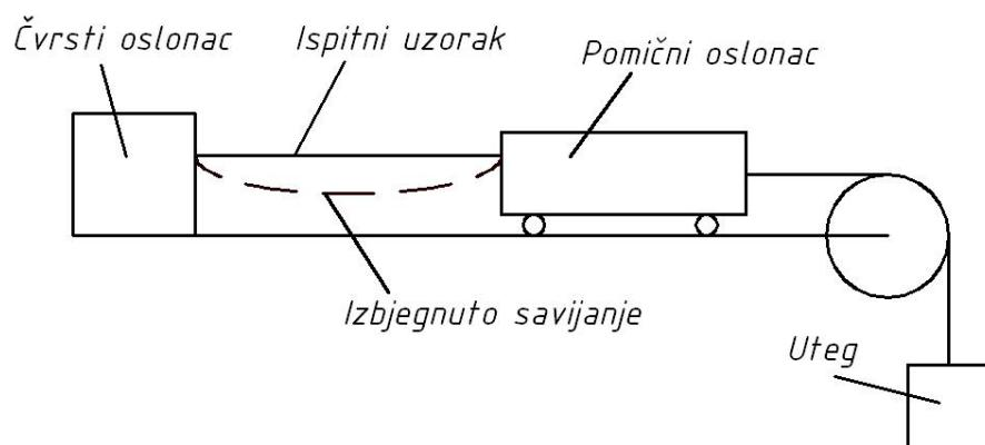
*Slika 5.4 Osiguranje čistog uvijanja elastičnih uzoraka aksijalnim predopterećenje*
