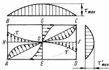
Slika 3.4 Raspored posmičnih naprezanja u štalu pravokutnog presjeka koji je opterećen na uvijanje [3]
