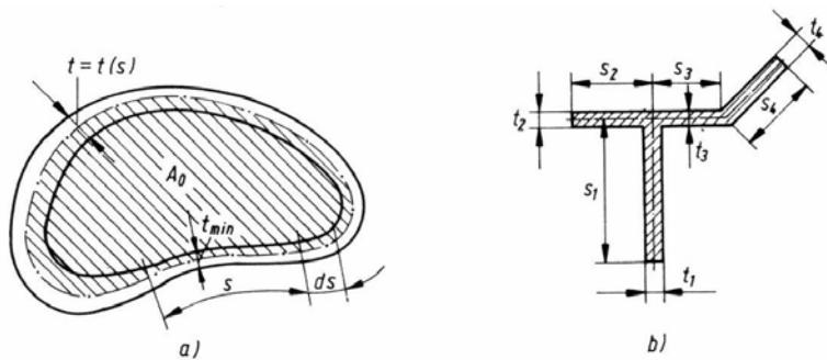
Slika 3.5 Poprečni presjek tankostjenog štapa: a) zatvoren presjek, b) otvoren presjek
