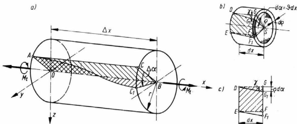
Slika 3.1 Geometrijska analiza uvijanja elementa kružnog štapa [3]
