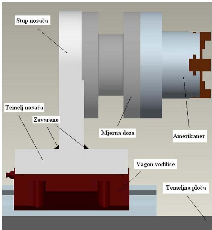
*Slika 6.3 Konstrukcijsko rješenje pomičnog oslonca*
