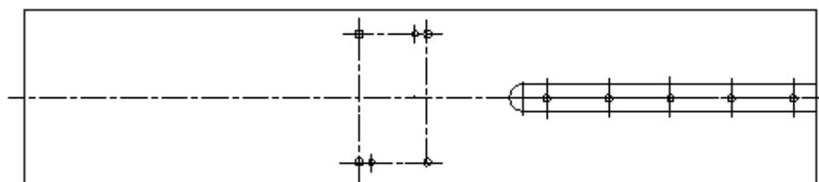
*Slika 6.4 Utori i žljebovi na temeljnoj ploči uređaja*
