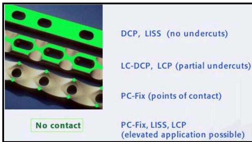
*Slika 2.6 Pločice različitih oblika kontaktnih površina [1]*
