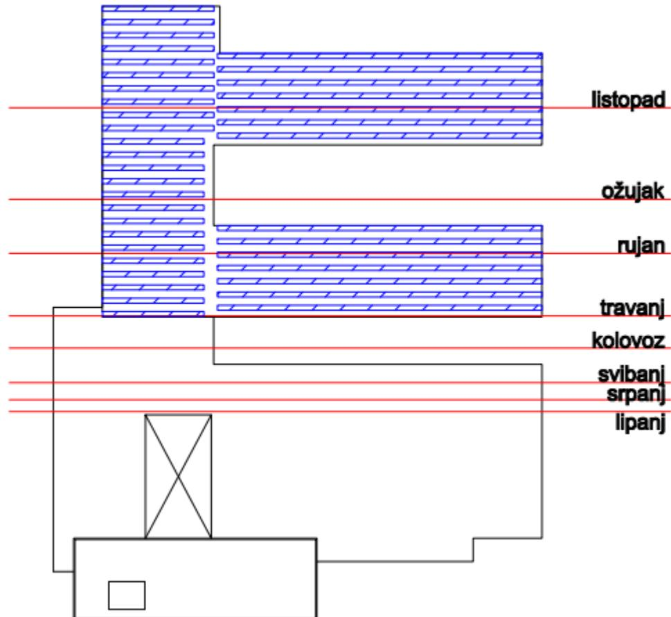
**Slika 10 Krovište visokog prizemlja s PV modulima i zasjenjivanjem**
