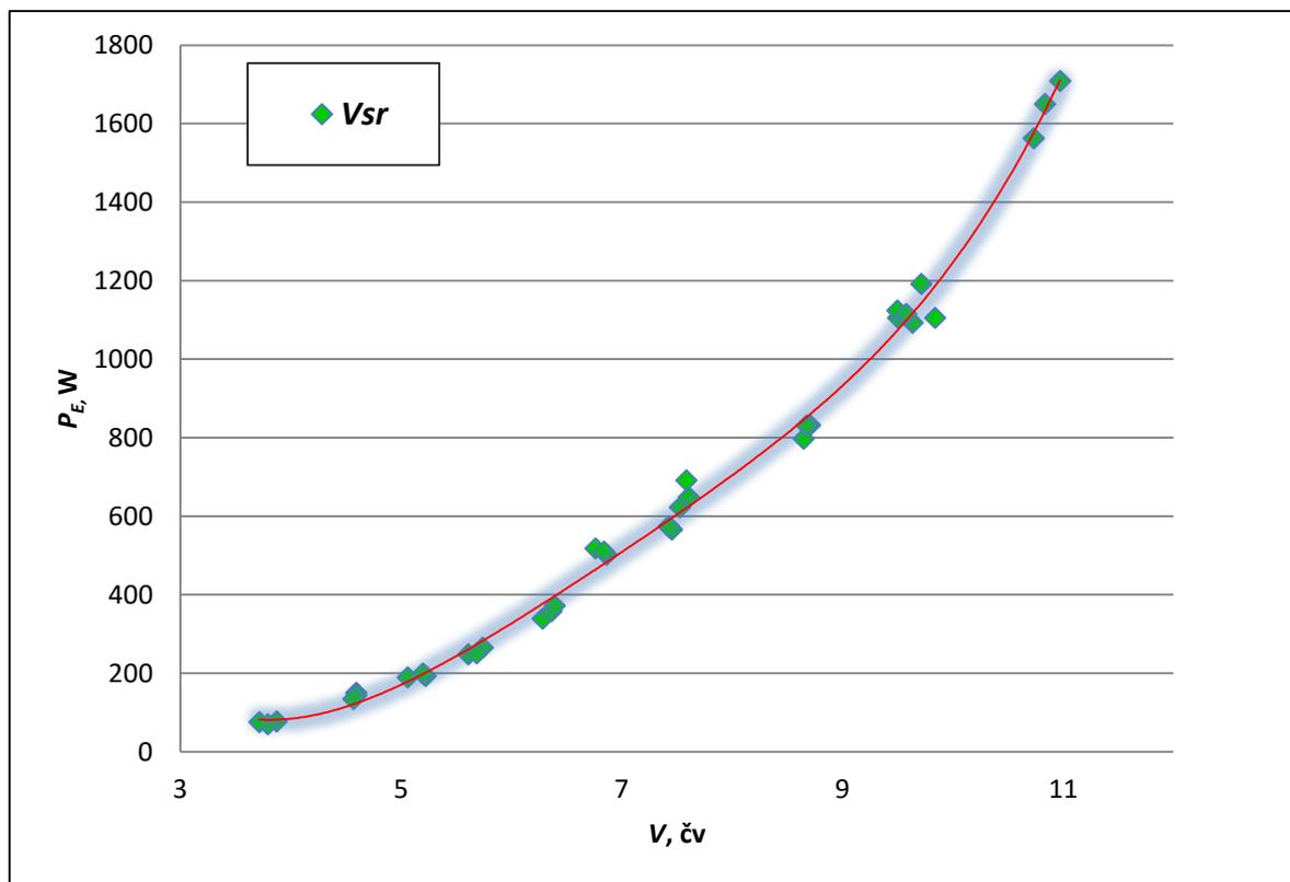
Slika 45. Ovisnost snage i srednje vrijednosti brzine brodocikla u četvrtoj vožnji
