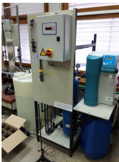
Slika 11. Miješani filter i TKA uređaj
