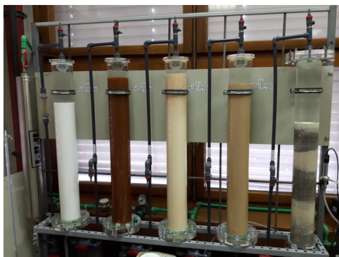
Slika 10. Filtar s aktivnim ugljenom i četiri ionska filtra
