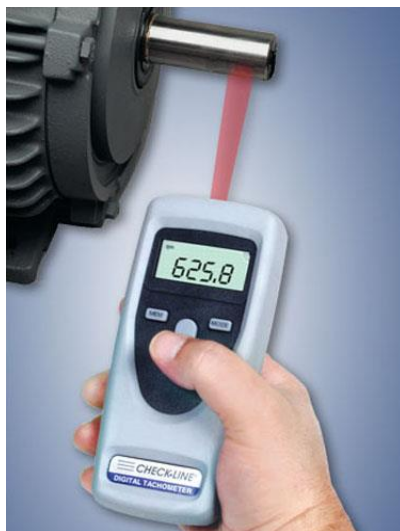
Slika 35. Primjer laserskog tahometra
