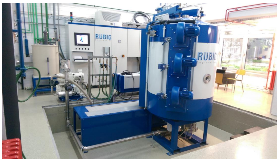
Slika 3.3 Uređaj za prevlačenje Rübige PC 70/90
