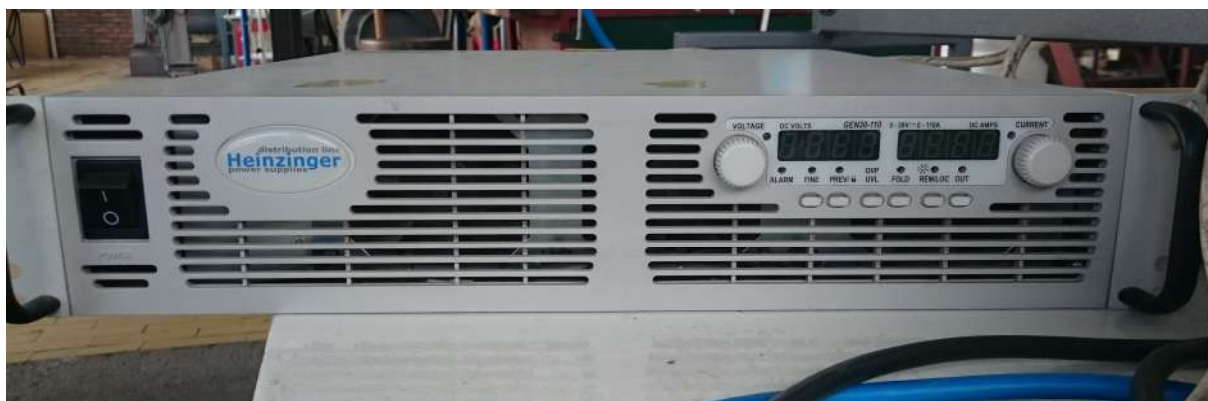
Slika 39. DC/DC laboratorijski izvor napajanja- Heinzinger.
