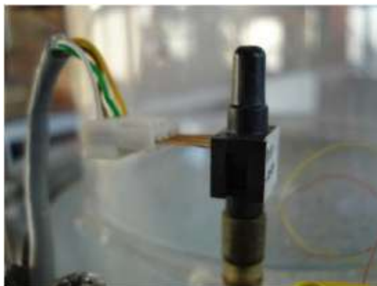
Slika 41. Osjetnik diferencijalnog tlaka PX26 - 001 DV [2].
