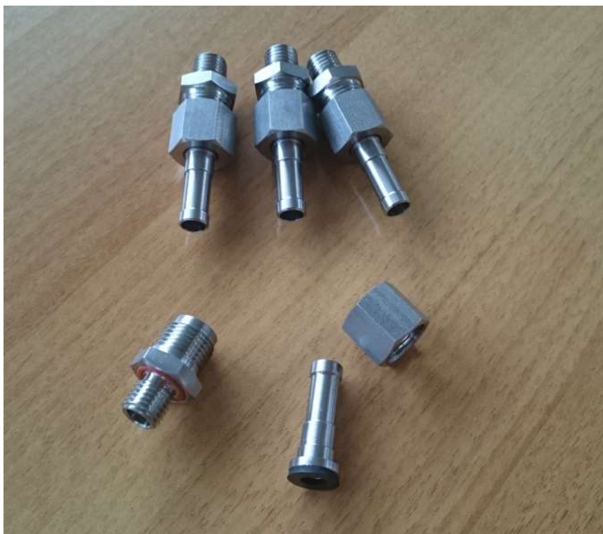
Slika 28. Priključci za dovod i odvod elektrolita – fotografija.
