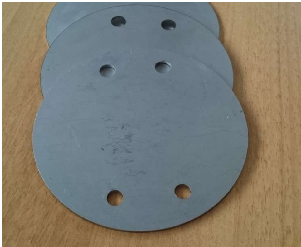
Slika 16. Bipolarne ploče - fotografija.
