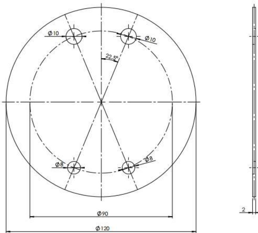
Slika 14. Bipolarna ploča – nacrt.
