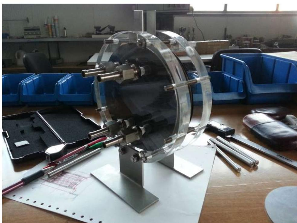
**Slika 8.** Alkalni ektrolizator bipolarne izvedbe\_2 - fotografija.
