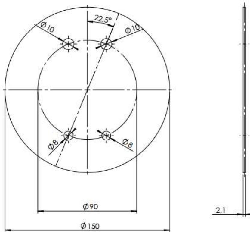
**Slika 21.** Brtva uz rubnu ploču - nacrt.
