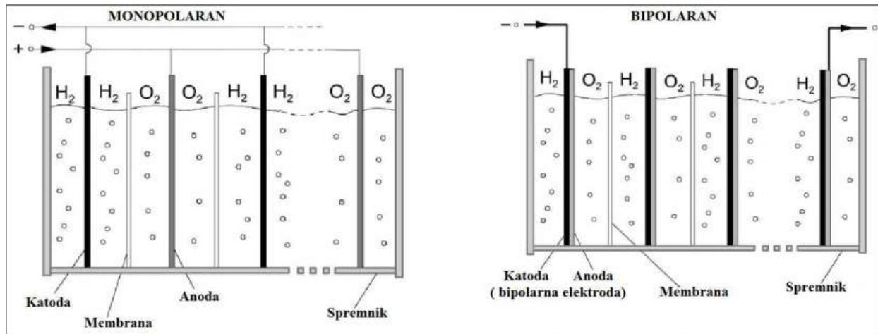
Slika 2. Monopolarna i bipolarna izvedba elektrolizatora [1].
