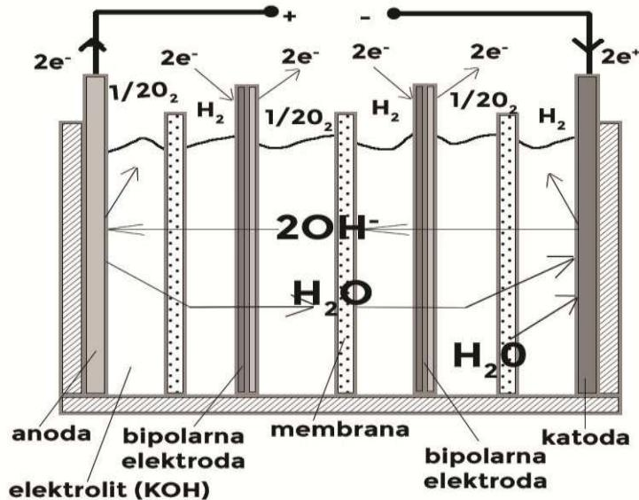
Slika 3. Pojednostavljena shema bipolarne izvedbe alkalnog elektrolizatora.
