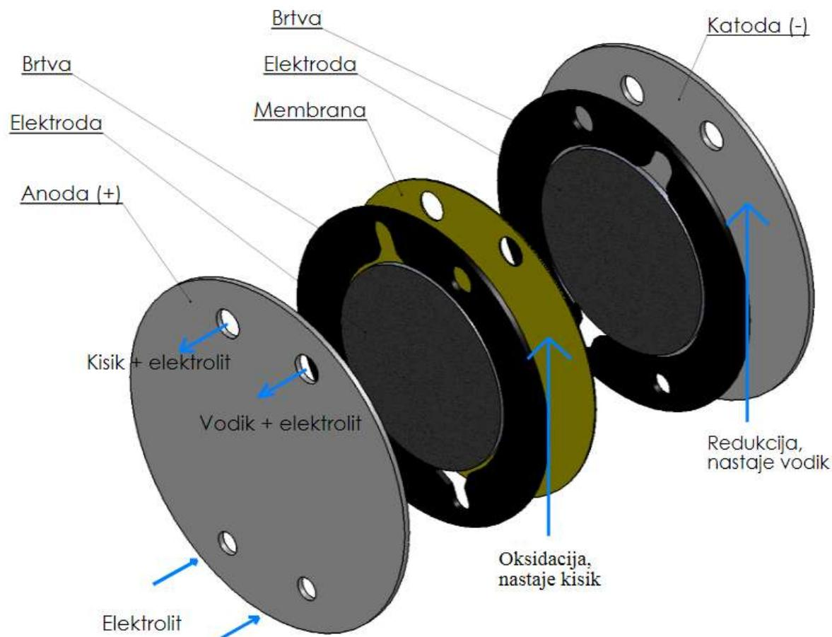
**Slika 5.** Strujanje elektrolita i plinova unutar jednog članka.
