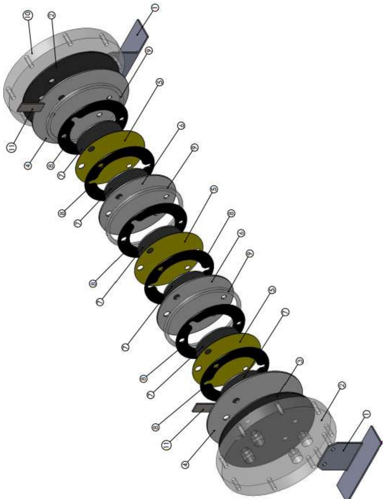
**Slika 6.** Prikazbipolarne izvedbe alkalnogelektrolizatora s označenim pozicijama.
