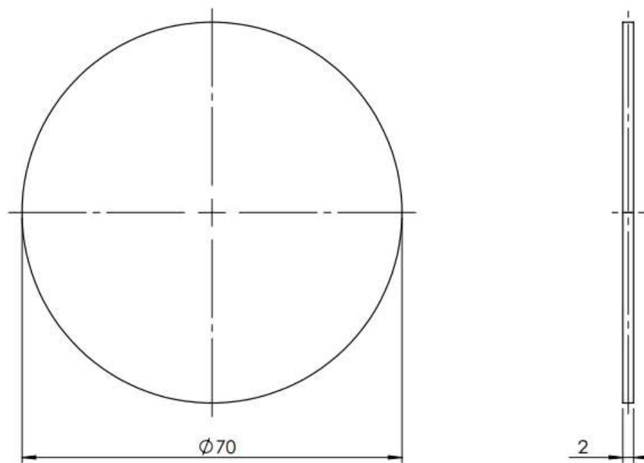
**Slika 23.** Elektroda – nacrt.
