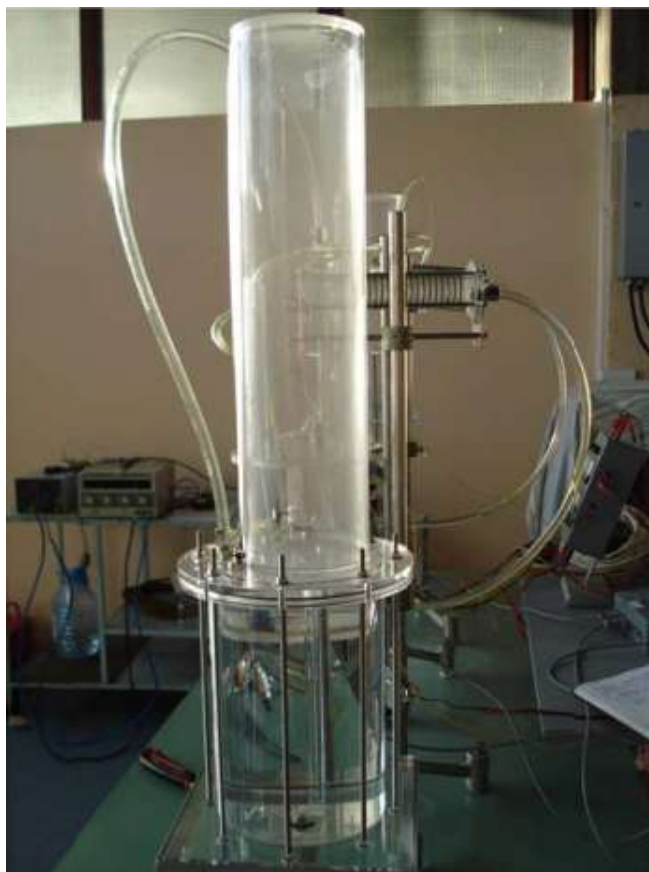
Slika 34. Spremnik za pohranu nastalih plinova [2].
