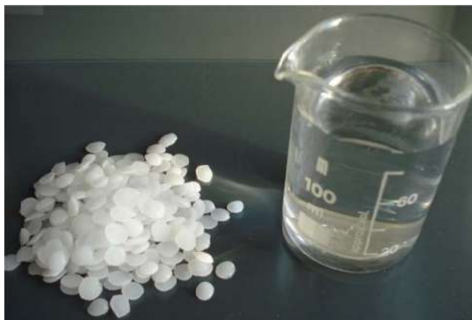
Slika 37. Priprema elektrolita: granule KOH lijevo i destilirana voda desno [2].
