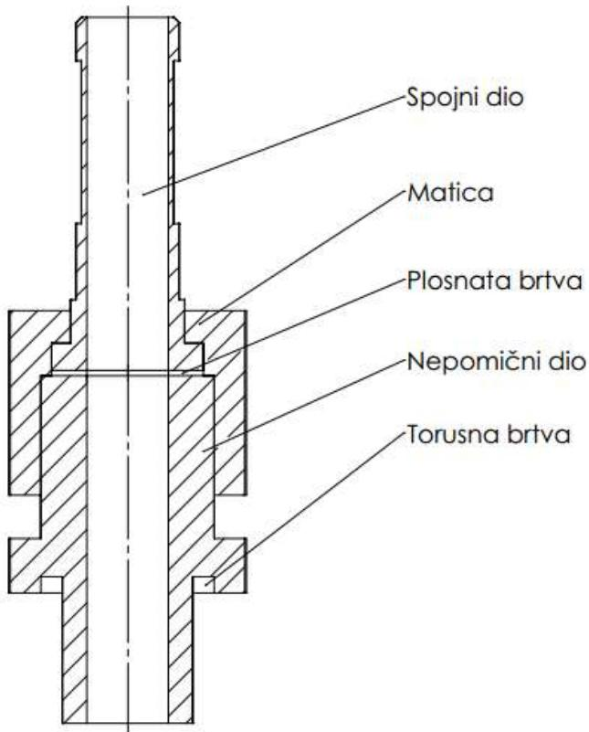
**Slika 27.** Priklučak za dovod i odvod elektrolita - sklopni crtež.
