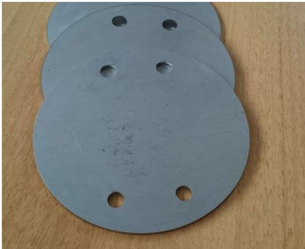
Slika 16. Bipolarne ploče - fotografija.
