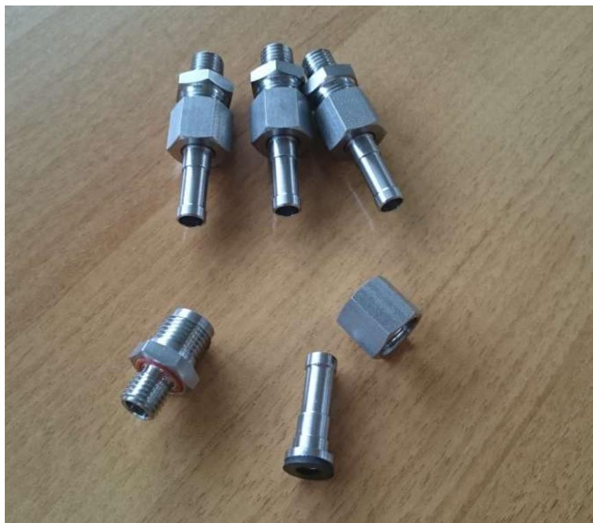
**Slika 28.** Priklučci za dovod i odvod elektrolita – fotografija.
