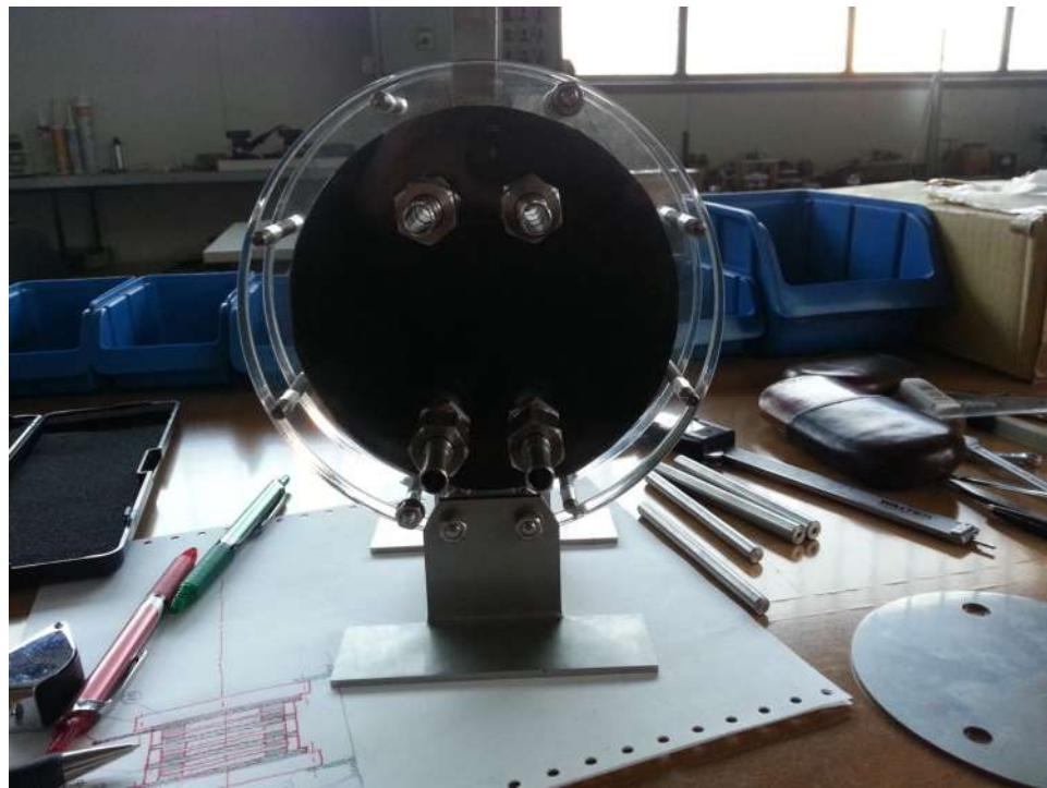
**Slika 7.** Alkalni elektrolizator bipolarne izvedbe\_1 - fotografija.
