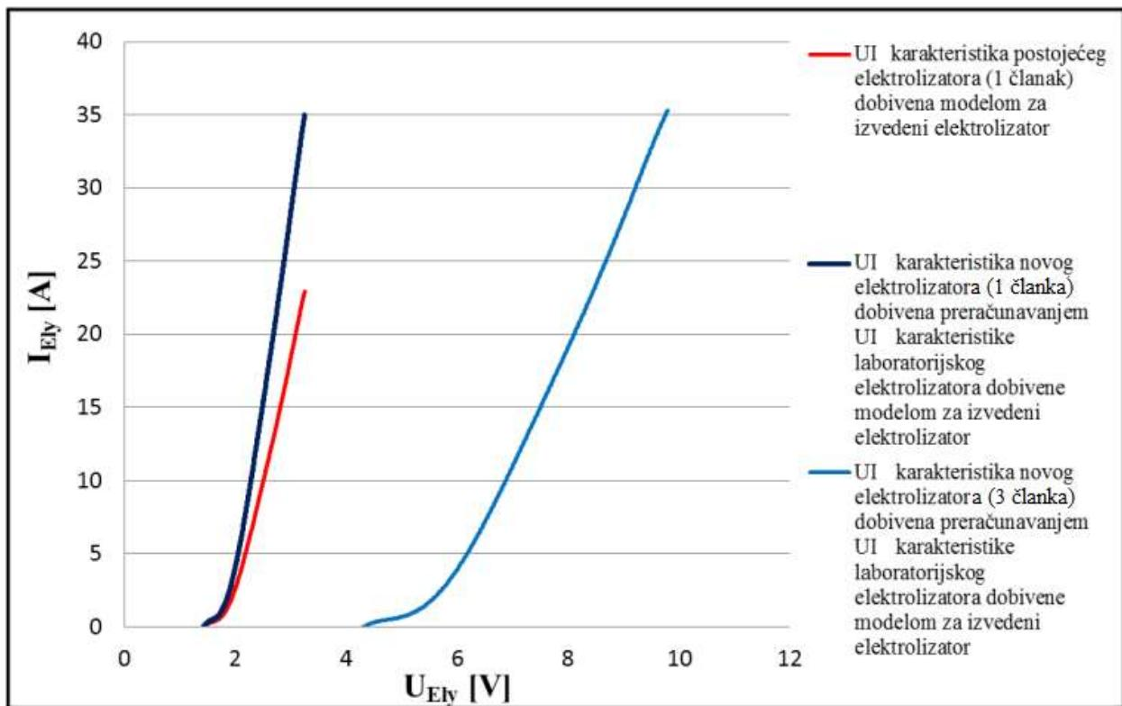
Slika 4. Usporedba UI karakteristika postojećeg i novog elektrolizatora [1].
