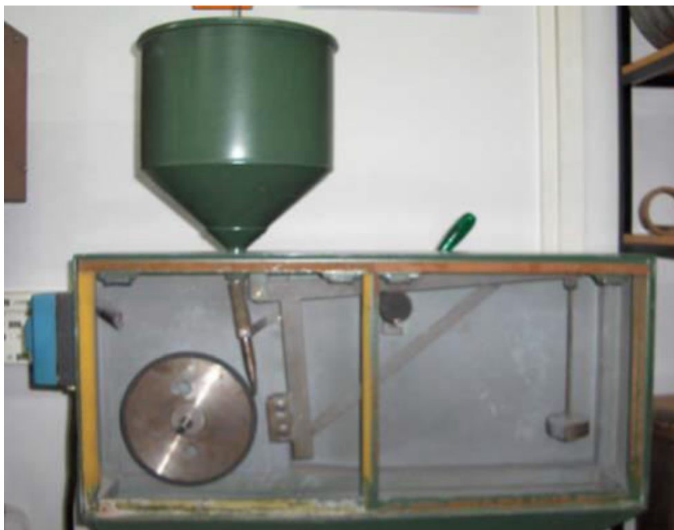
Slika 20. Uređaj “suhi pijesak/gumeni kotač”
