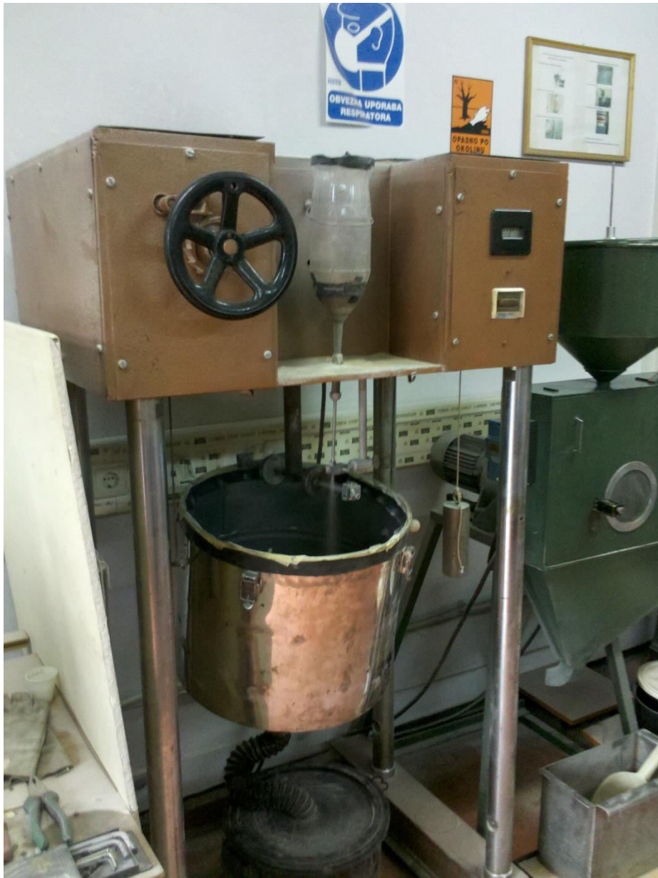
Slika 23. Uređaj za ispitivanje otpornosti na erozijsko trošenje
