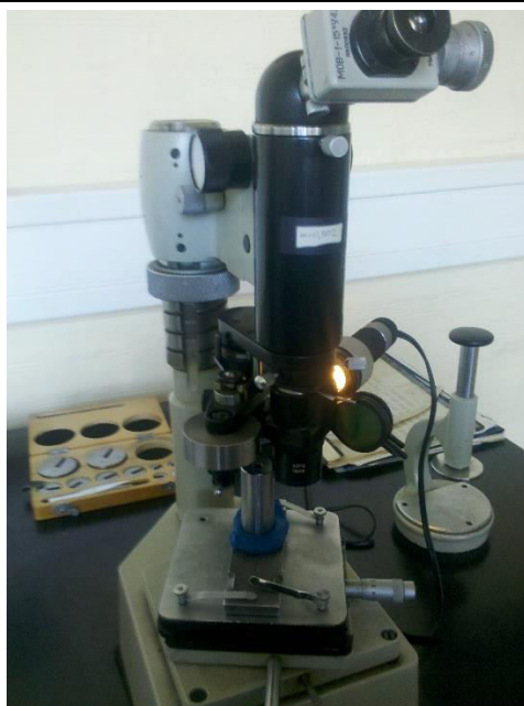
Slika 18. Mjerenje tvrdoće po Vickersu
