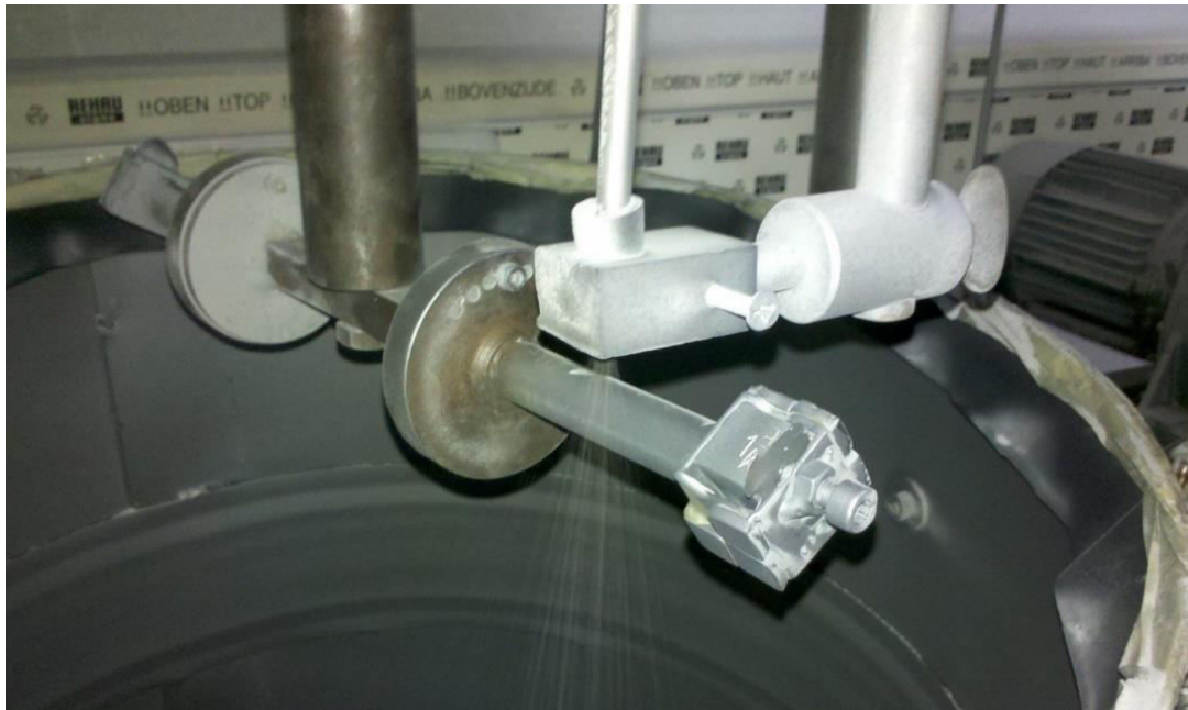
Slika 24. Glava držača sa pričvršćenim uzorkom i sapnica
