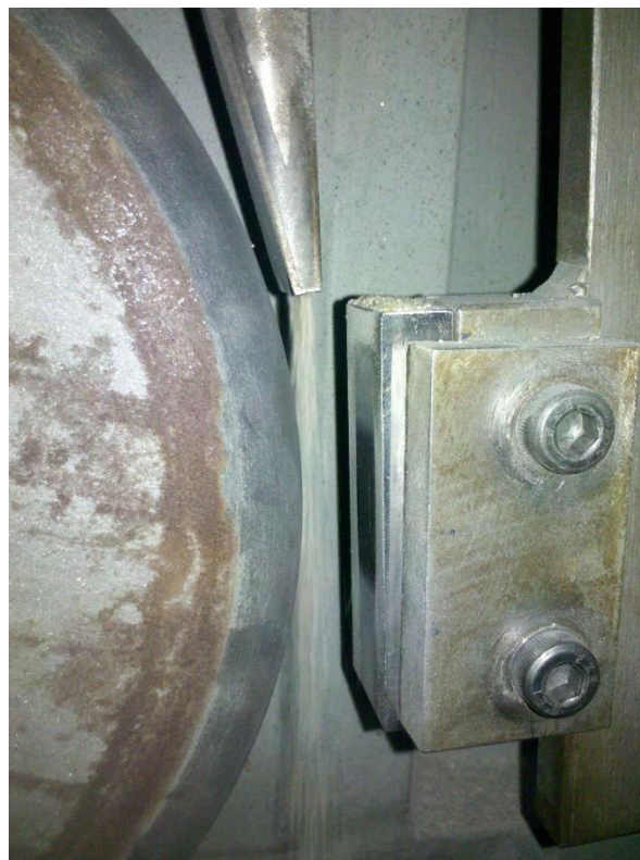
Slika 21. Detalj uređaja i trag trošenja na uzorku
