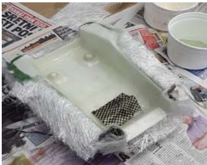
Slika 18. Proizvodnja kućišta od staklenog ojačanja i epoksidne smole
