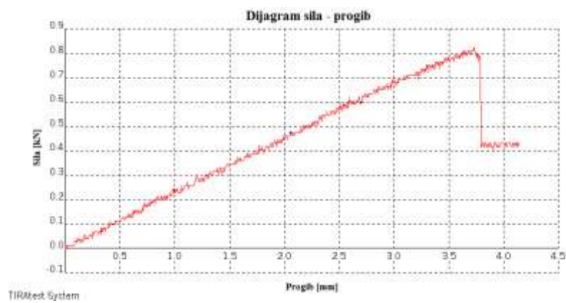
Slika 45. Dijagram sila – progib za kompozit A – epruveta 3
