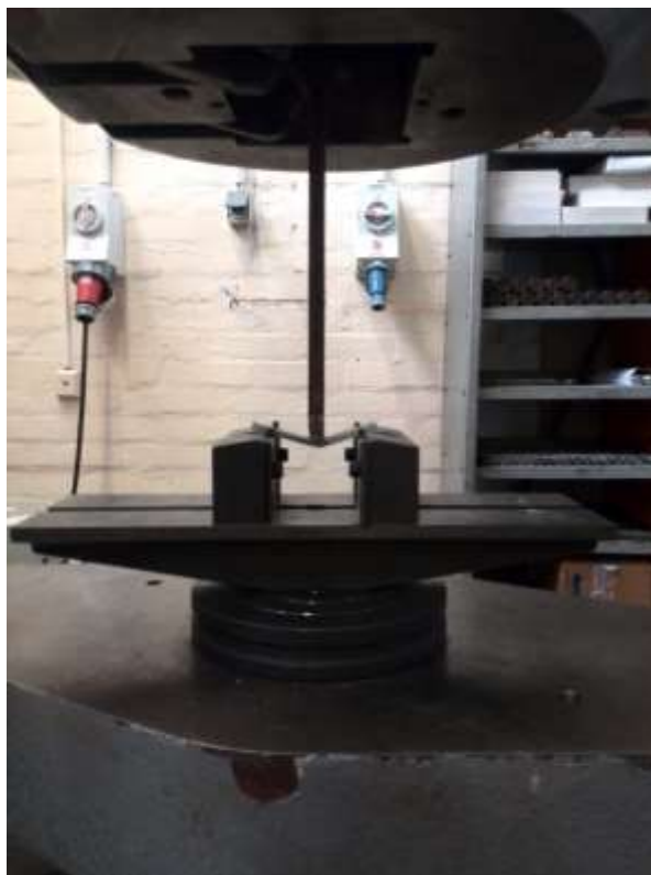
Slika 42. Ispitivanje savojne čvrstoće
