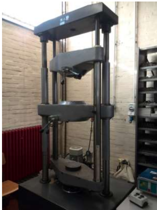
Slika 29. Kidalica EU 40mod proizvođača WPM
