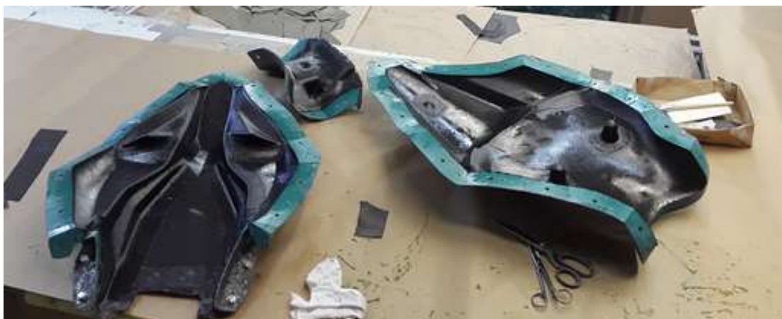
Slika 19. Proizvodnja sjedišta motocikla od ugljičnog ojačanja i epoksidne smole
