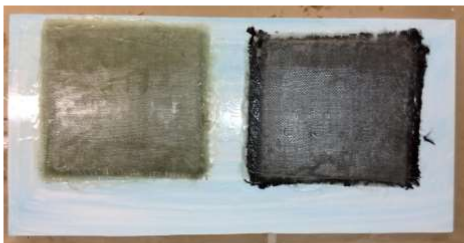
Slika 28. Smolom natopljena staklena i ugljična ojačanja
