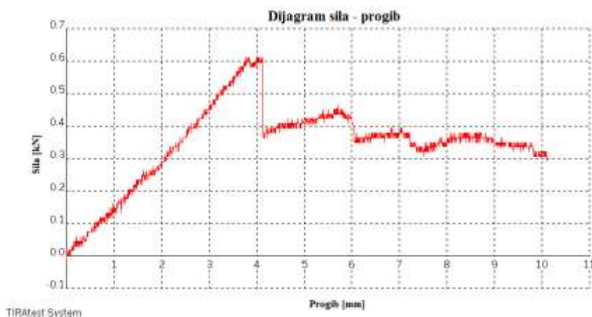
Slika 43. Dijagram sila – progib za kompozit A – epruveta 1
