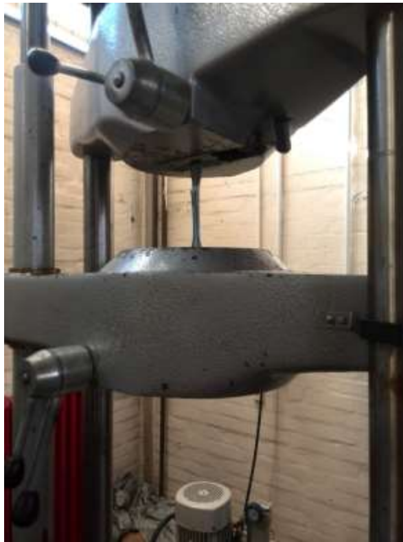
Slika 31. Statičko vlačno ispitivanje
