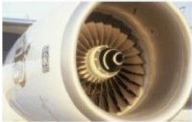
Slika 5 Mlazni motor izrađen od titanove legure [1]
