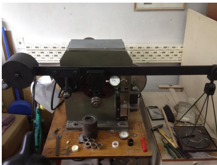
Slika 38 Uređaj za ispitivanje adhezije „Block on ring“ metodom
