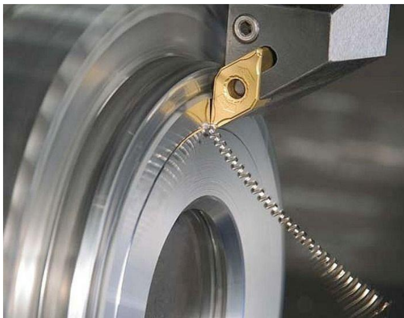
Slika. 7. Vanjsko poprečno tokarenje [12]
