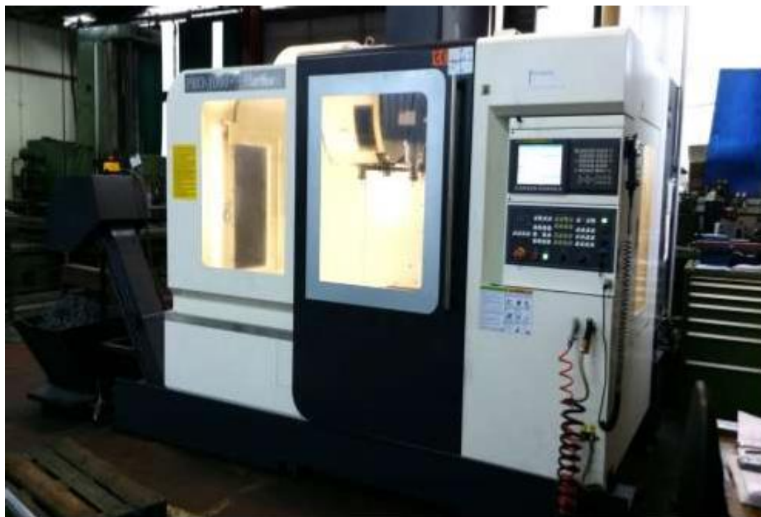
Slika. 22. Troosna CNC glodalica Hartford PRO 1000 [21]
