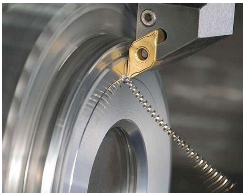
Slika. 7. Vanjsko poprečno tokarenje [12]
