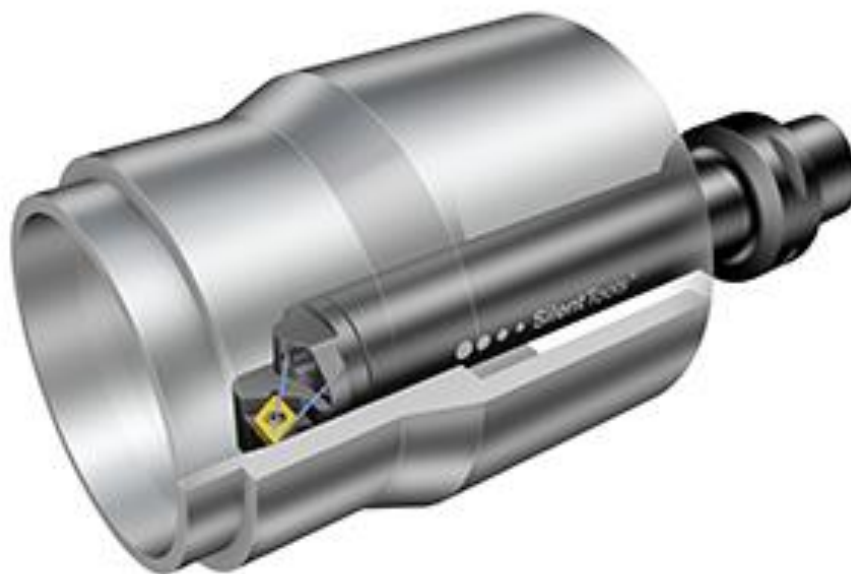
Slika. 6. Unutarnje uzdužno tokarenje [11]
