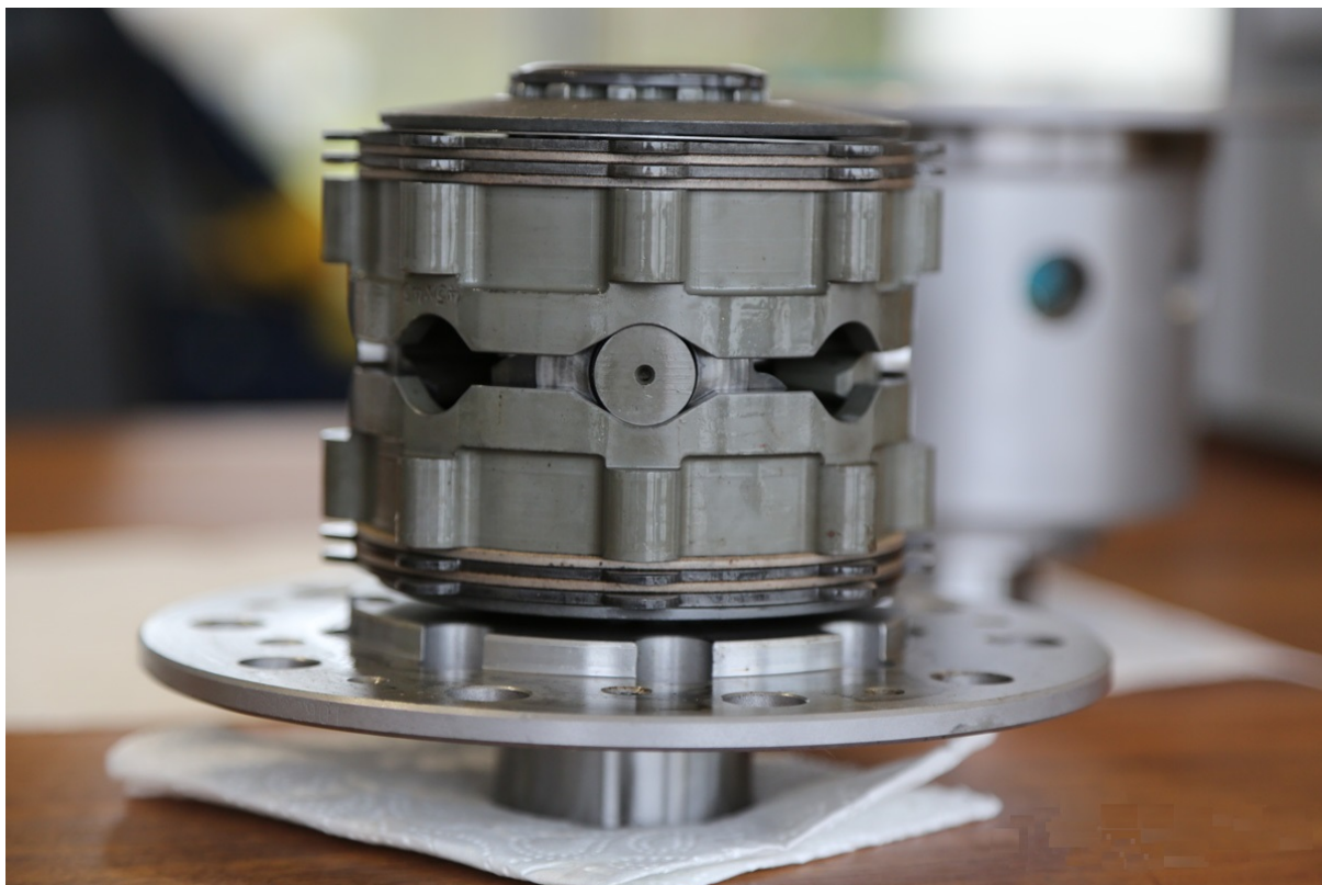
Slika 8. Ilustrativni prikaz unutrašnjosti „LSD“ lamelnog diferencijala
