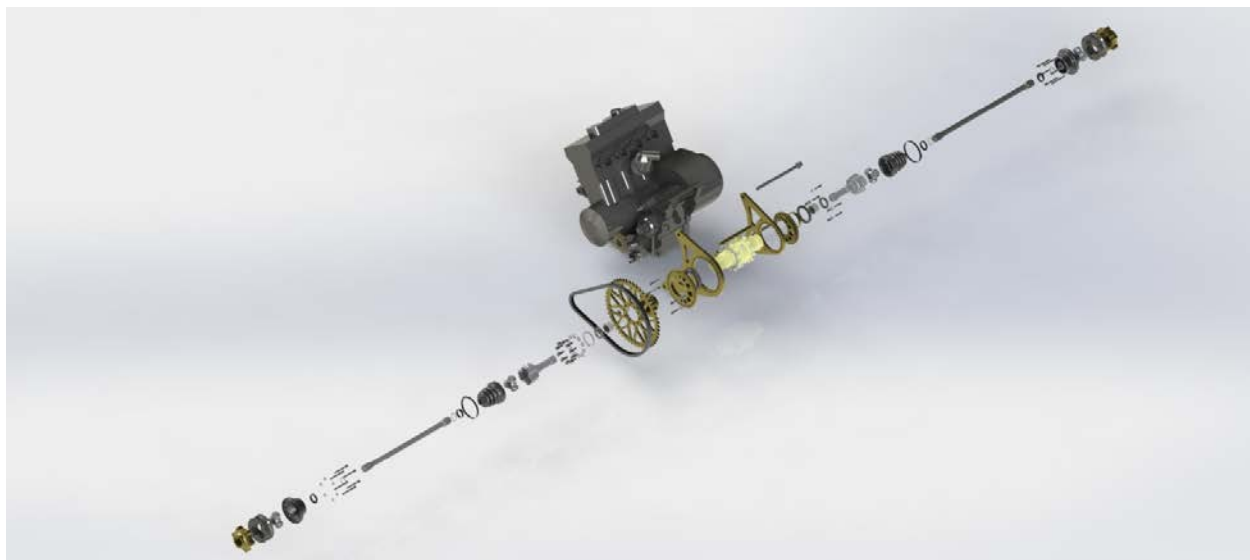
Slika 3. Primjer sustava sa eksternim ovješanjem diferencijala i prijenosa lanceom
