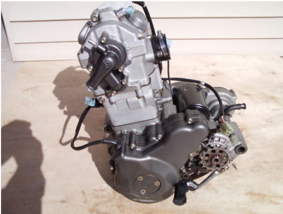
Slika 4. Jednocilindrični motor proizvođača Husqvarna, mase 42 kg
