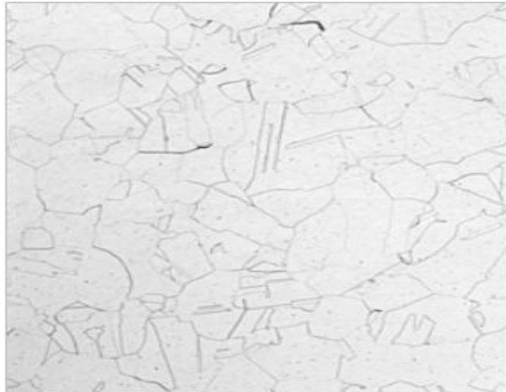
Slika 2. Mikrostruktura austenitnog nehrđajućeg čelika [6]
