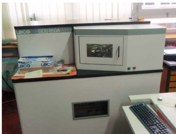
Slika 31. Uređaj za optičku emisijsku spektroskopiju s tinjajućim izbojem Leco GDS 850A
