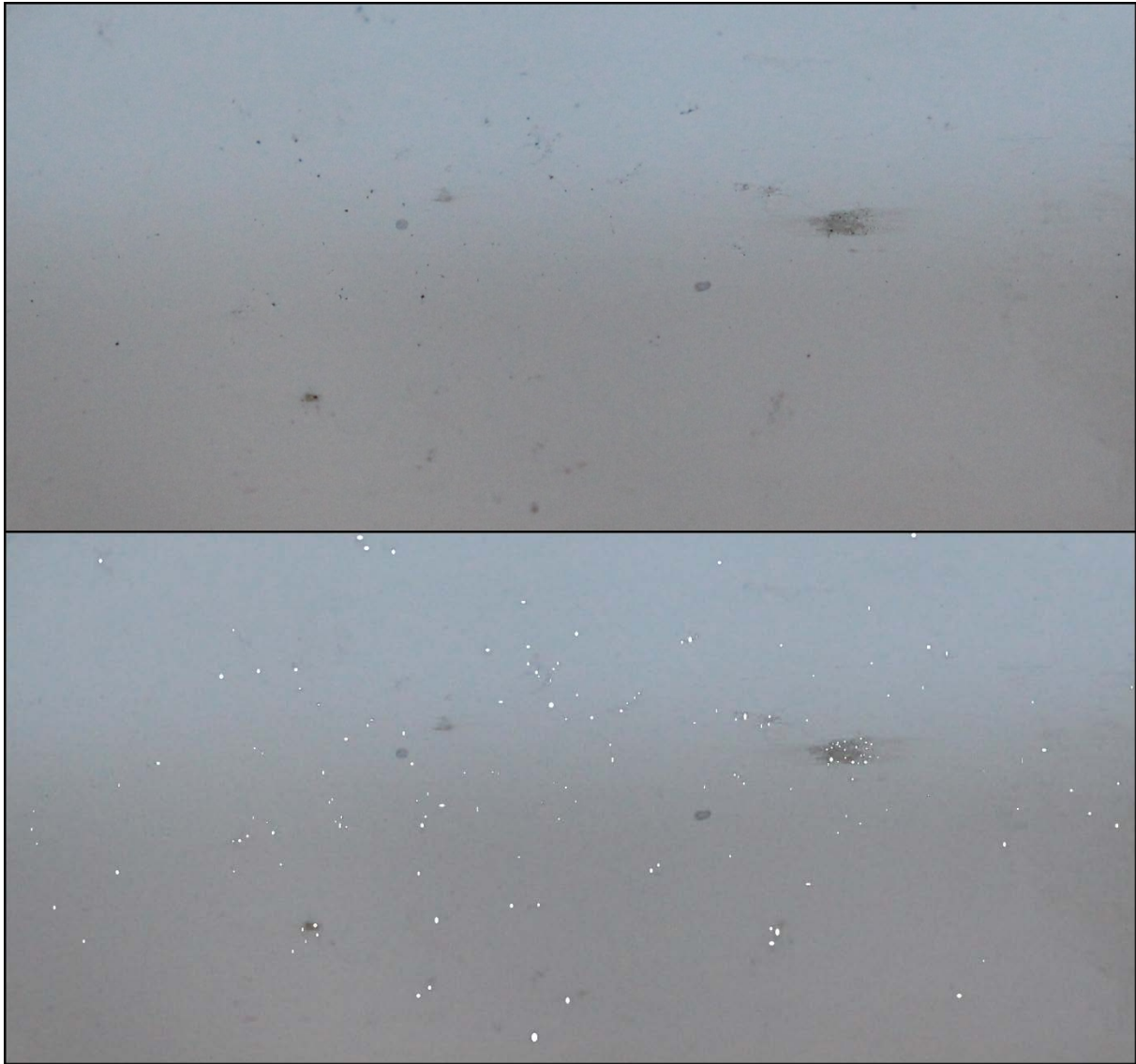
Slika 58. Mjerenje površine rupica poliranog uzorka u programu "ImageJ"
