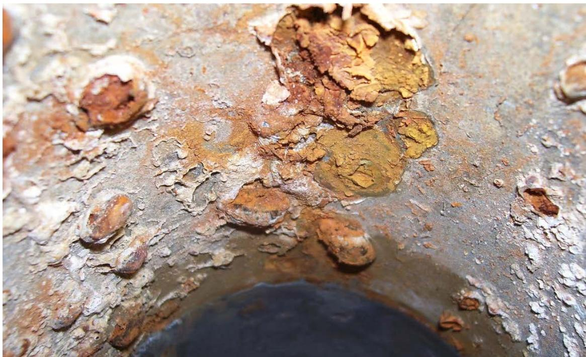
**Slika 15. Mikrobiološki poticana korozija na unutarnjoj stijenci cijevi od nehrđajućeg čelika [22]**
