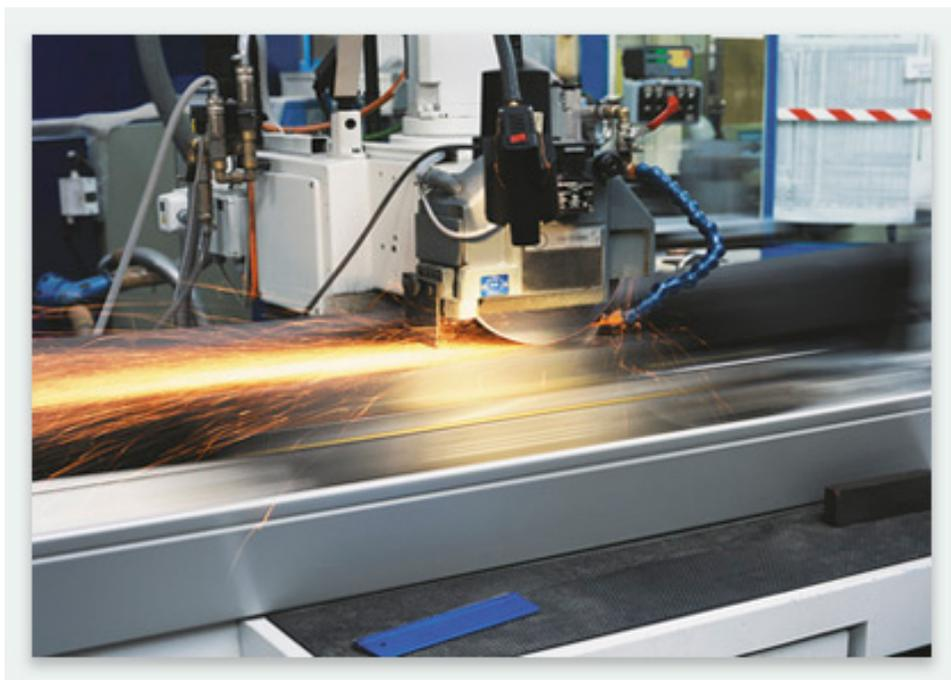
Slika 2. Strojno brušenje metala [4]
