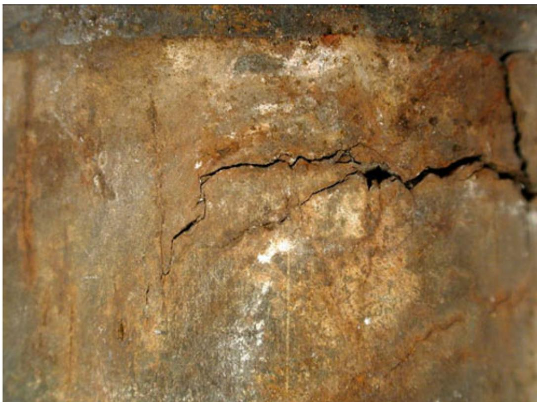
**Slika 13. Austenitni nehrđajući čelik (316Ti) zahvaćen napetosnom korozijom [19]**
