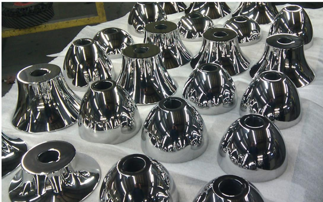
Slika 3. Polirani čelični dijelovi valjaka [5]
