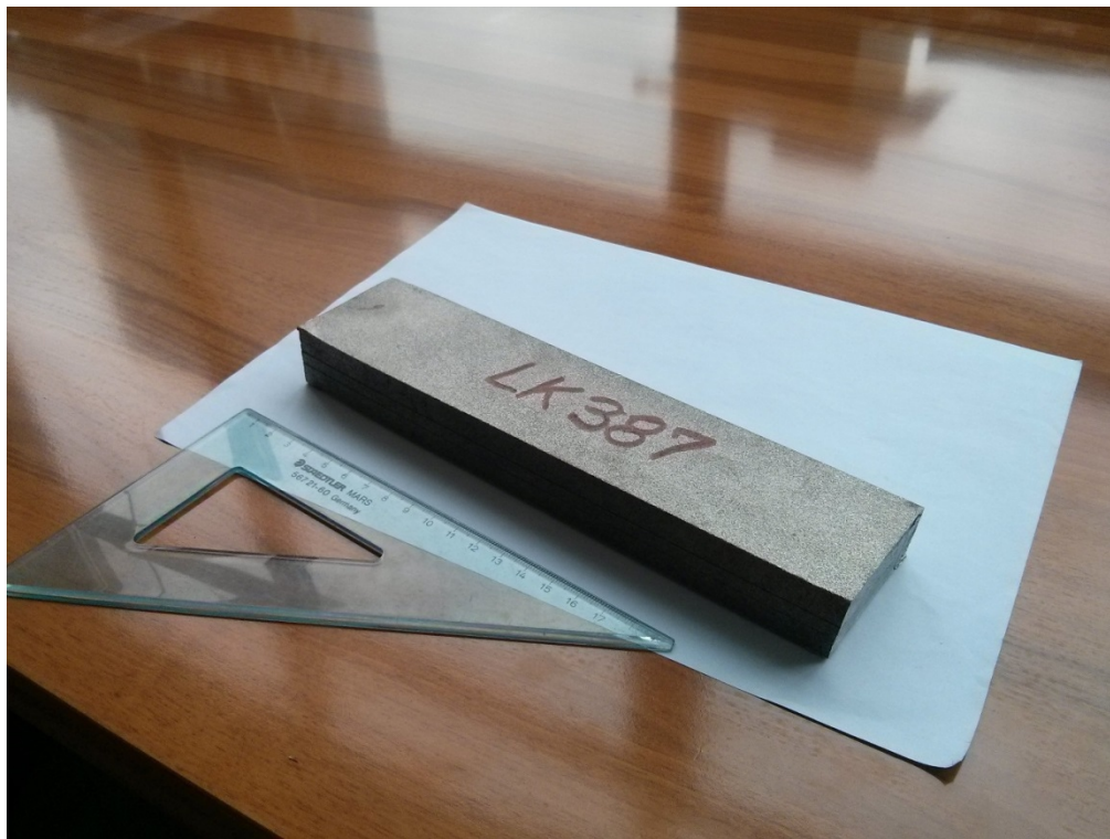
Slika 30. Odljevak od dupleks nehrđajućeg čeličnog lijeva
