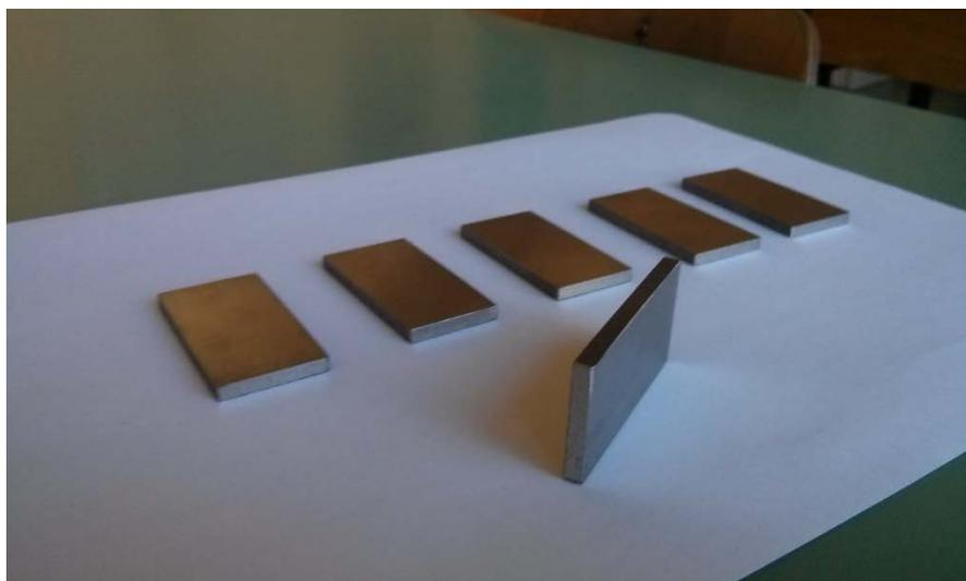
Slika 48. Uzorci za ispitivanje sklonosti rupičastoj koroziji
