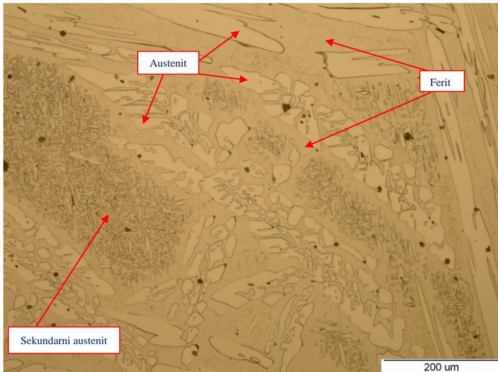
Slika 38. Mikrostruktura dupleks nehrđajućeg lijeva, svjetlosni mikroskop
