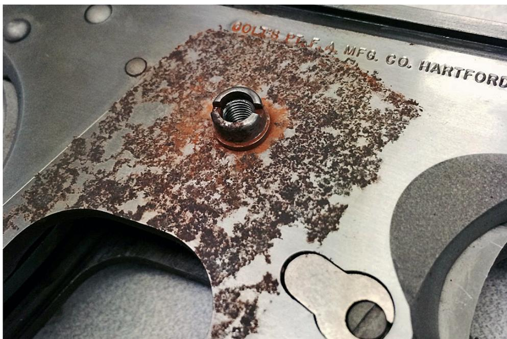
Slika 7. Rupičasta korozija Colt pištolja od nehrđajućeg čelika [12]
