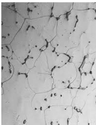
**Slika 21. Mikrostruktura austenitnog nehrđajućeg čeličnog lijeva CF3M [33]**
