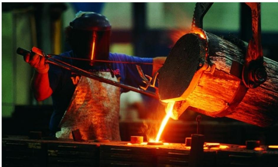
Slika 16. Lijevanje čelika [24]
