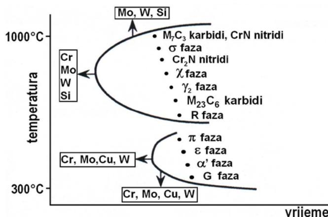
Slika 28. Shematski prikaz tipičnih precipitacija u dupleks čelicima [26]
