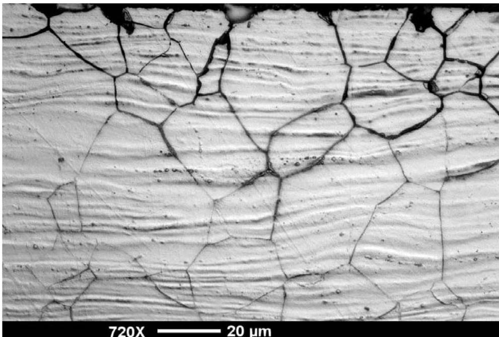
**Slika 8. Intekristalna korozija hladno valjanog austenitnog nehrđajućeg čelika [13]**
