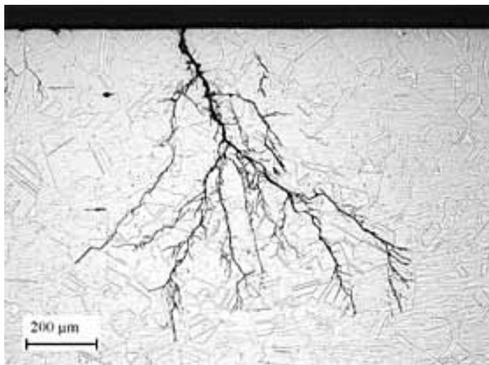
**Slika 12. Napetosna korozija austenitnog čelika (316L) [17]**
