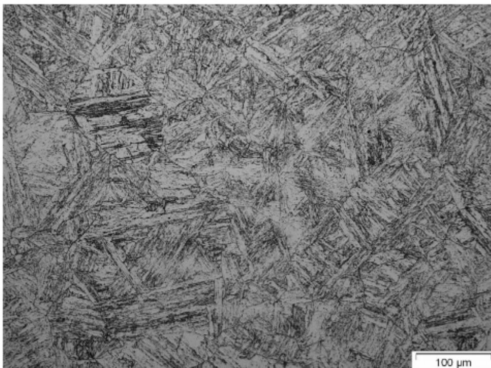
**Slika 20. Mikrostruktura martenzitnog nehrđajućeg čeličnog ljeva CA6NM [32]**
