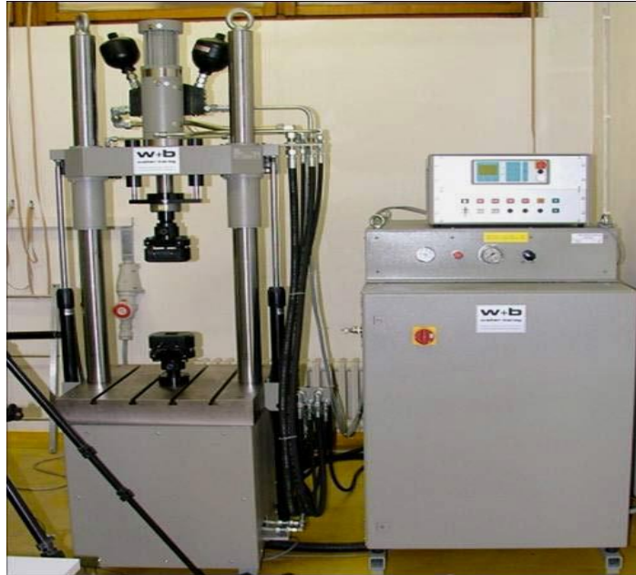
Slika 12. Servo-hidraulička umaralica Walter+Bai LFV-50-HH
