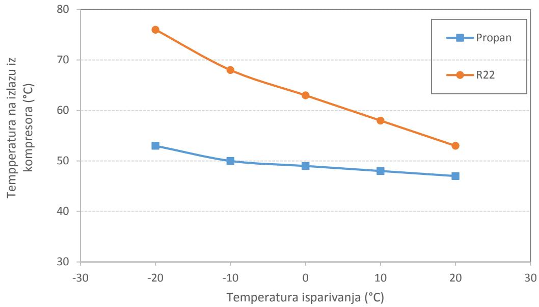
**Slika 9 Temperatura na izlazu iz kompresora u odnosu na temperaturu isparivanja,
