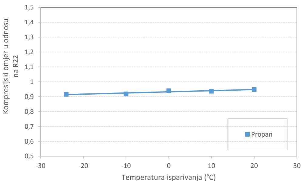
**Slika 4 Kompresijski omjer propana u odnosu na R-22 pri razlici temperatura izmedju kondenzacije i isparivanja od 40 °C**
