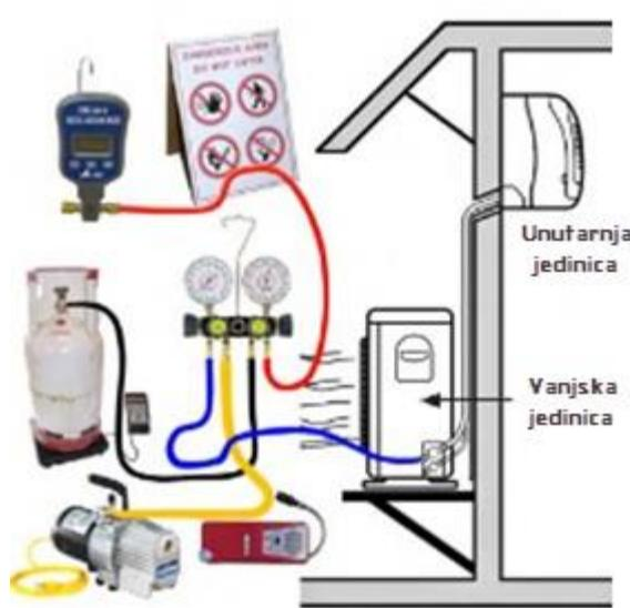
Slika 31 Oprema za vakumiranje i punjenje sustava [5],[12]
