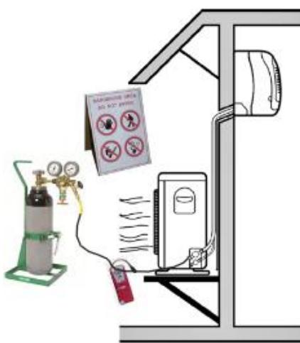
Slika 27 Tlačna proba [4]
