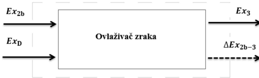
Slika 10. Shema eksergijske destrukcije u ovlaživaču zraka vodenom parom
