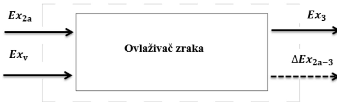
**Slika 7. Shema eksergijske destrukcije u ovlaživaču zraka s vodom**
