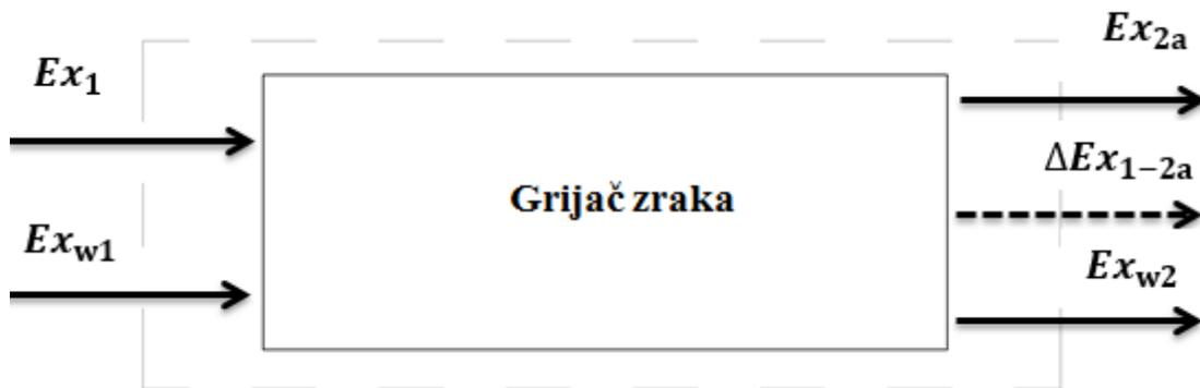
Slika 6. Shema eksergijske destrukcije u grijaču zraka grijanog vodom
