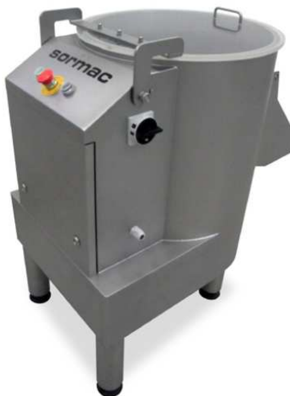
Slika 15 Stroj za ljuštenje model MSM-20 [6]
