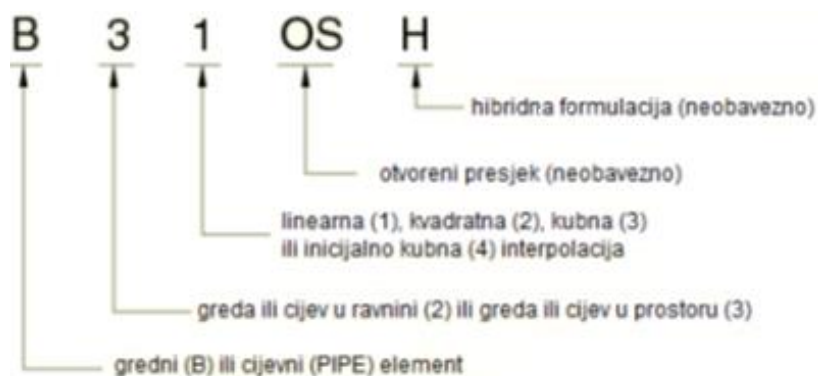
Slika 3. Imenovanje grednih elemenata u Abaqusu [3]
