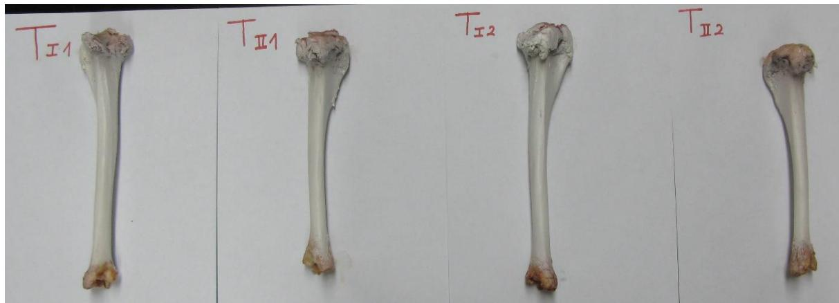
**Slika 19. Ispitni uzorci s nanesenom bijelom bojom**
