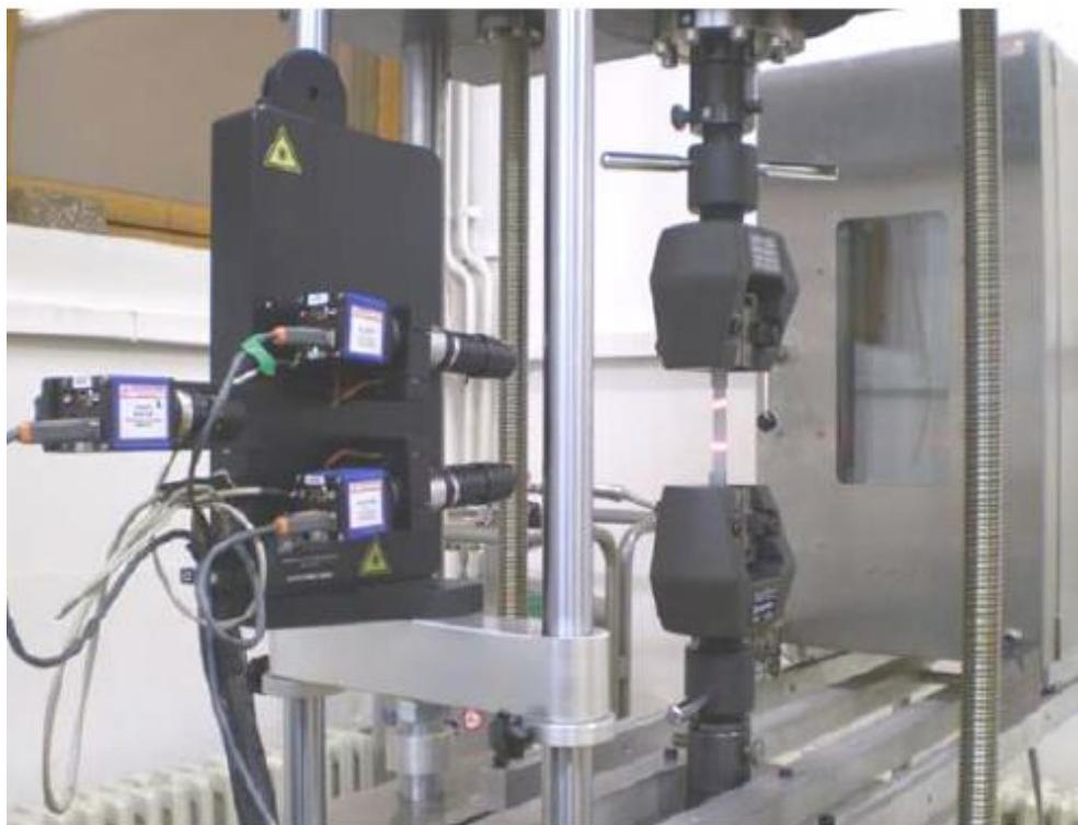
Slika 6. Mjerenje pomaka laserskim ekstenzometrom [1]
