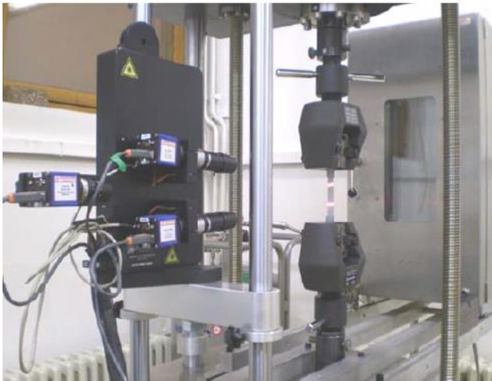
Slika 6. Mjerenje pomaka laserskim ekstenzometrom [1]
