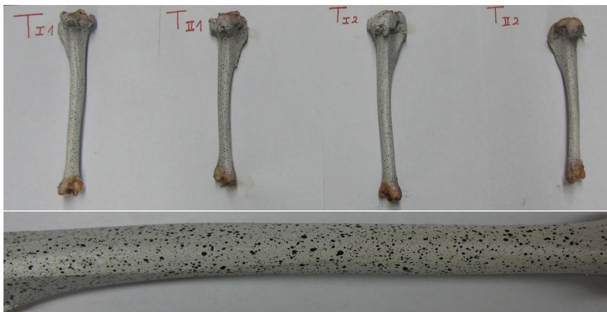
**Slika 20. Dobiveni stohastički uzorak na ispitnim uzorcima**
