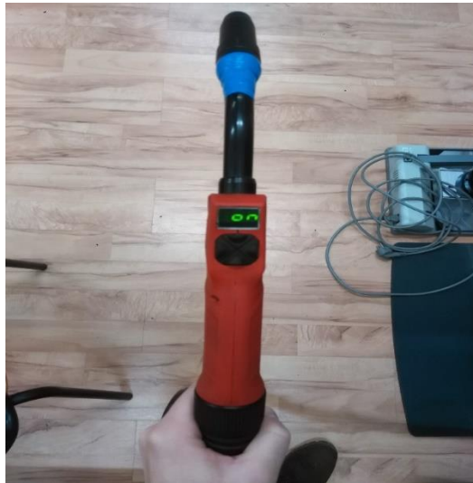
Slika 4.14. Gorionik s JobMaster funkcijom.
