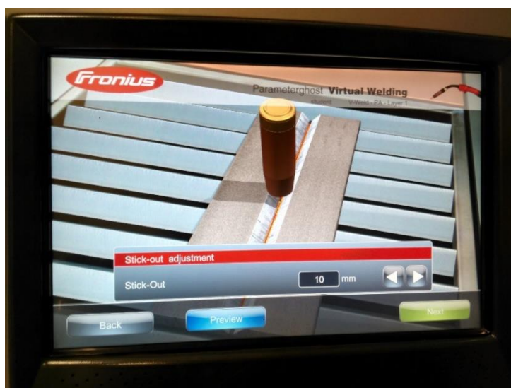
Slika 4.42. Postavljanje izlazne duljine žice.
