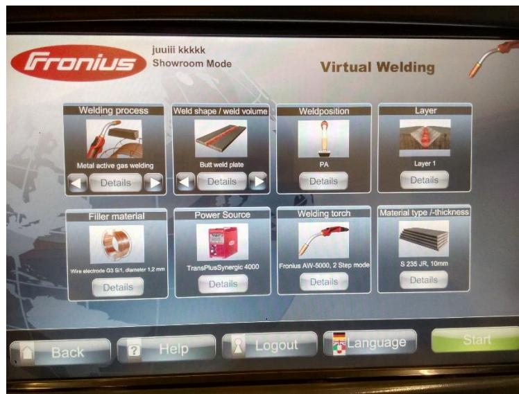
Slika 4.18. Odabir parametara virtualnog zavarivanja.
