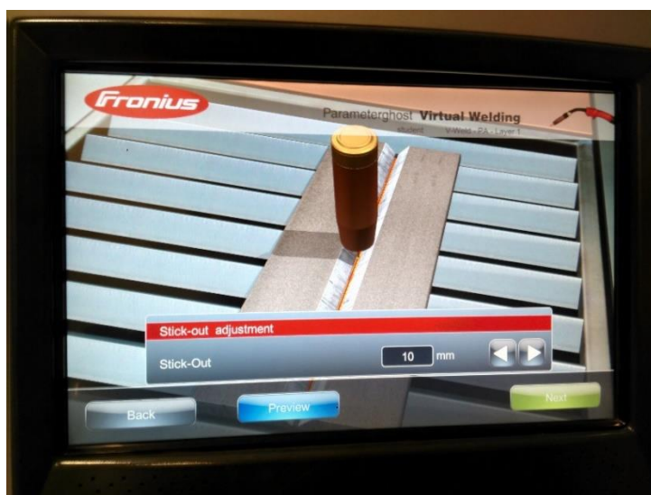
Slika 4.42. Postavljanje izlazne duljine žice.
