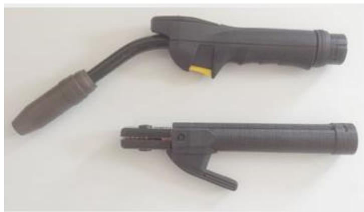
**Slika 3.24. Gorionik i držač elektrode za virtualno zavarivanje [16].**
