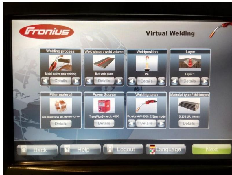
**Slika 4.33. Odabir parametara zavarivanja.**
