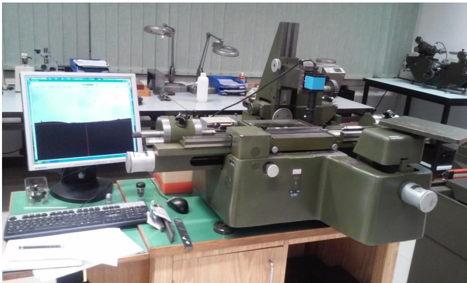
Slika 41. Uređaj za mjerenje tolerancije okomitosti ili kutnosti
