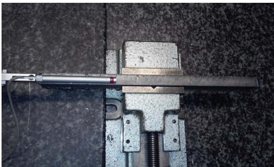
Slika 34. Mjerenje hrapavosti na uzorcima
