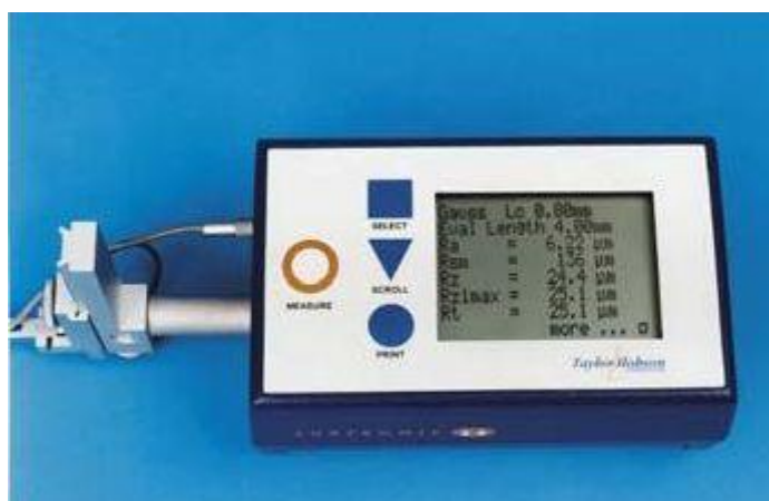
Slika 26. Uređaj za mjerenje hrapavosti SURTRONIC 25
