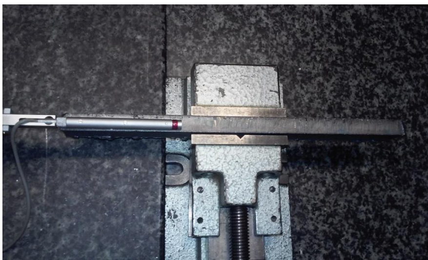
Slika 34. Mjerenje hrapavosti na uzorcima
