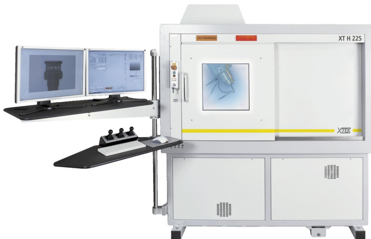
Slika 3. CT sustav za dimenzionalna mjerenja Nikon XT H 225
