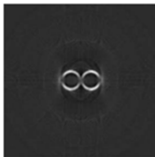
Slika 12. CT snimak s odstupanjem pomaka oko x- osi detektora [3]
