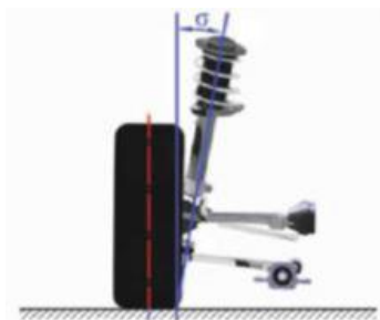
Slika 6. Bočni nagib osi zakreta kotača [1]
