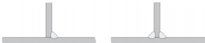
Slika 3. Jednostrano i dvostrano izveden T-spoj [3]
