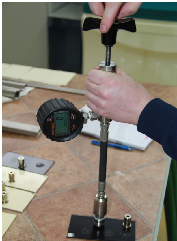
Slika 27. Ispitivanje prionjivosti premaza
