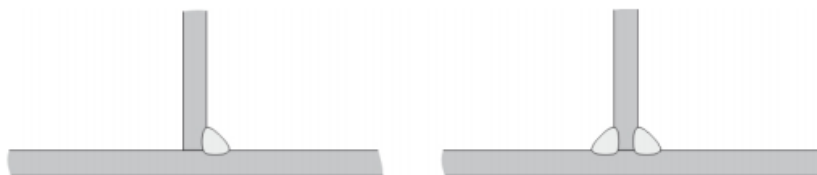
Slika 3. Jednostrano i dvostrano izveden T-spoj [3]
