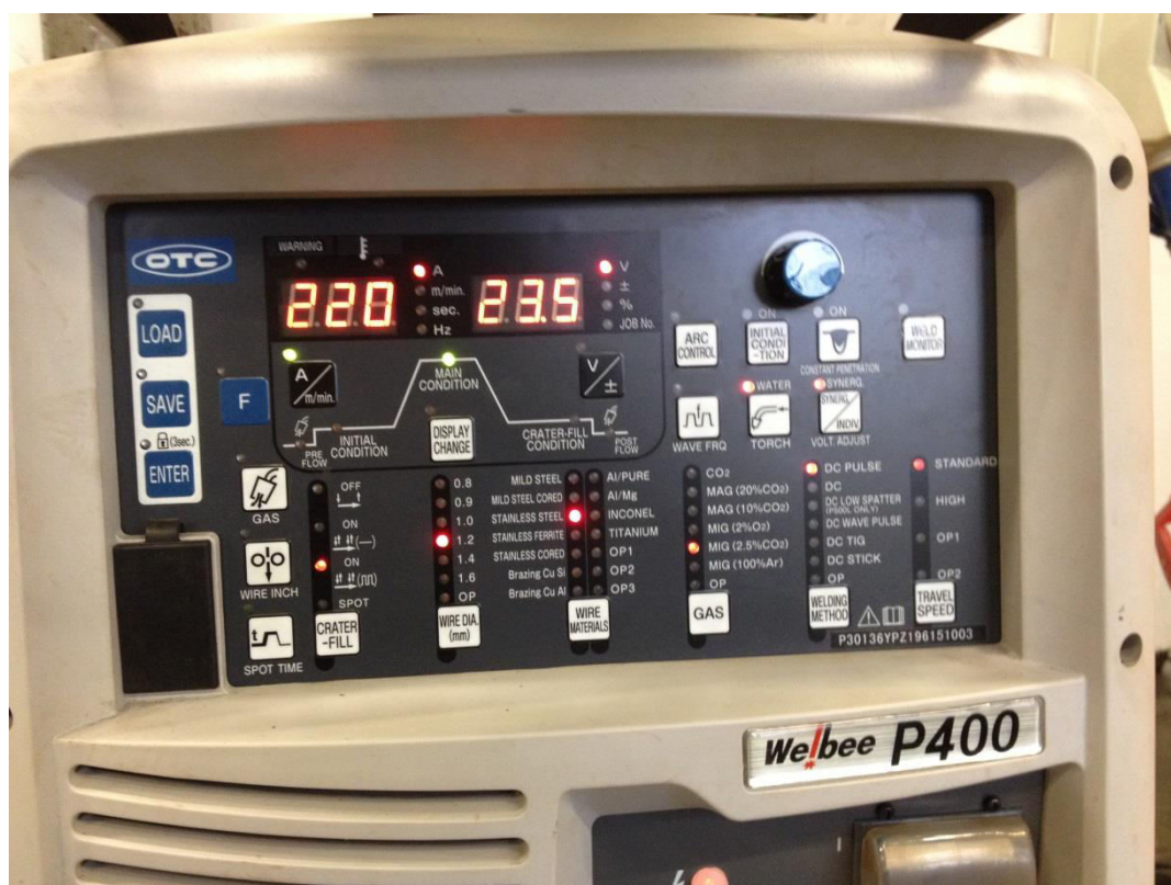
Slika 22. Podešeni parametri za zavarivanje uzorka „A“
