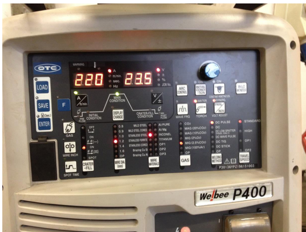
Slika 22. Podešeni parametri za zavarivanje uzorka „A“
