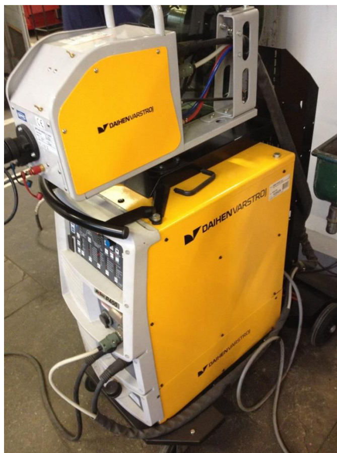
Slika 18. Izvor struje za zavarivanje Welbee Inverter P400
