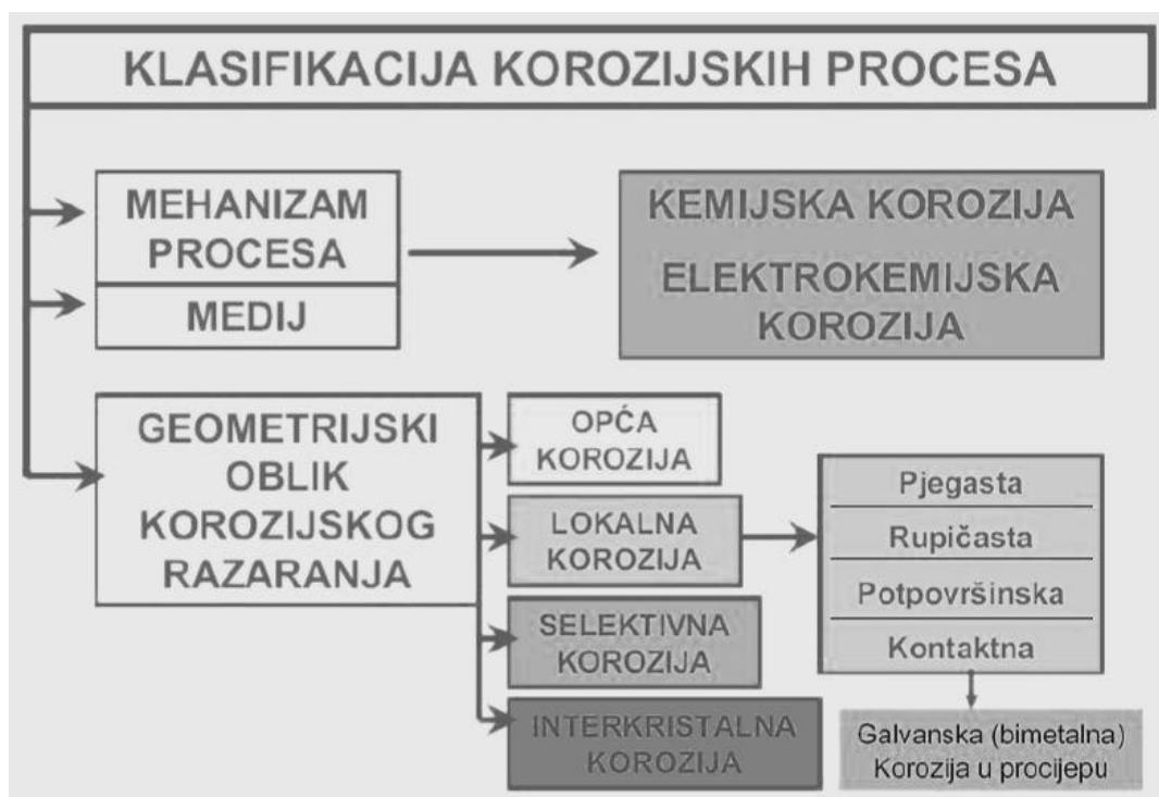
Slika 1. Klasifikacija korozijskih procesa [1]
