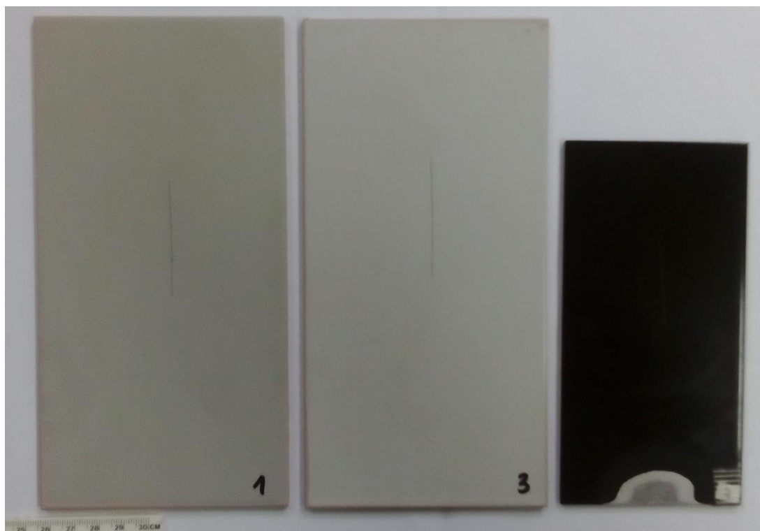
Slika 18. Ispitni uzorci prije stavljanja u slanu komoru [14]
