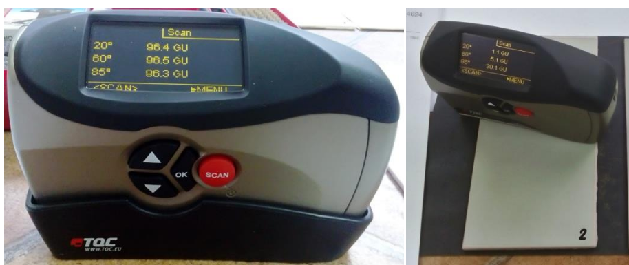
Slika 16. Instrument i postupak mjerenja sjaja [14]
