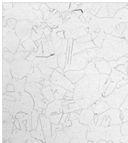
Slika 3. Mikrostruktura austenitnog nehrđajućeg čelika [8]
