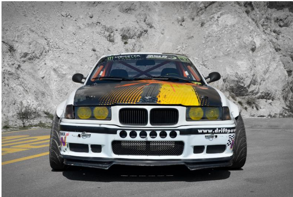
Slika 86 Negativni nagib kotača od 3 stupnja
