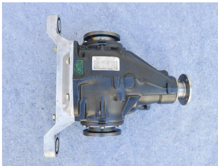
Slika 54 Samoblokirajući diferencijal u kućištu 210
